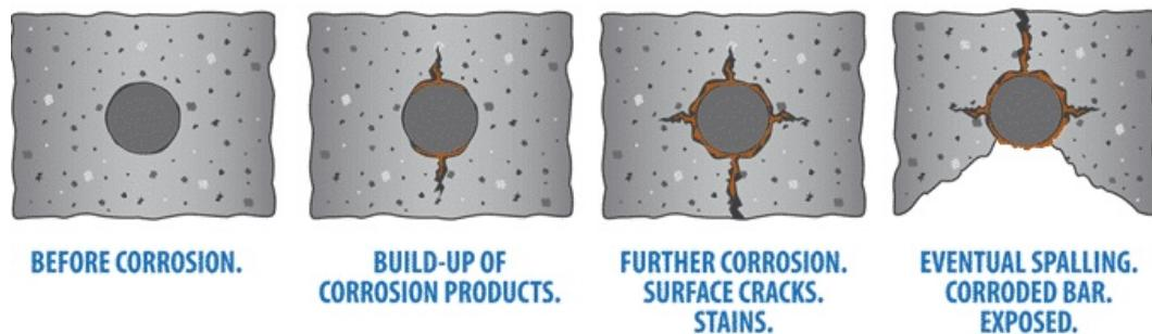
Slika 8: Procesi raspadanja betona (s lijeva na desno): a) prije korozije, b) nakupljanje korozije, c) širenje korozije, površinske pukotine, d) otpadanje površinskog sloja betona, izložena korodirana armatura [10]
