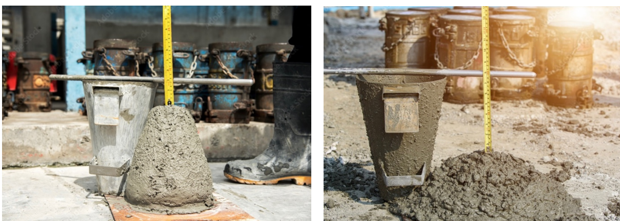
Slika 13: Oblik slijeganja betonske mješavine (s lijeva na desno): zadovoljavajući pravilan oblik slijeganja, nepravilan oblik slijeganja [16]
