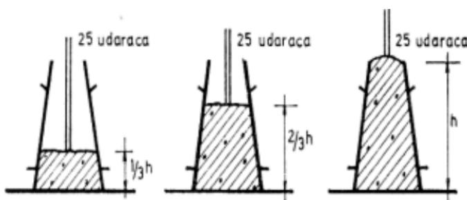
Slika 12: Postupak ispitivanja metodom slijeganja [15]
