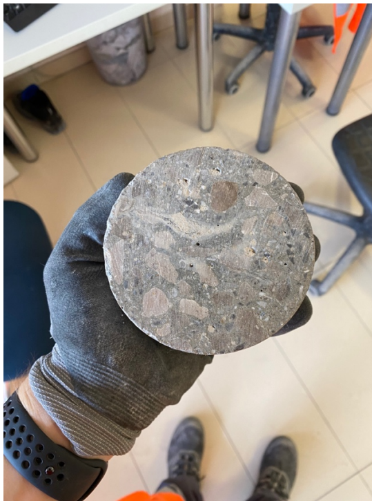
Slika 25: Presjek cilindričnog uzorka za ispitivanje, (izvor: vlastita fotografija)
