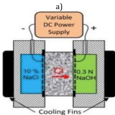
Slika 10: Shematski prikaz ispitivanja uzorka - NT BUILD 492 , a) varijabilni izvor istosmjernog napona , b) rashladni rešetkasti paneli [4]
