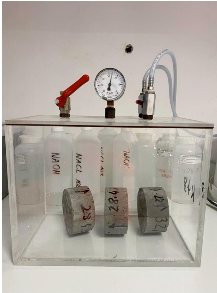
Slika 16: Ispitni uzorci postavljeni u eksikator, (izvor: vlastita fotografija)
