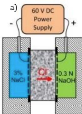
Slika 11: Shematski prikaz ispitivanja - ASTM C1202, a) izvor istosmjernog napona od 60V [4]
