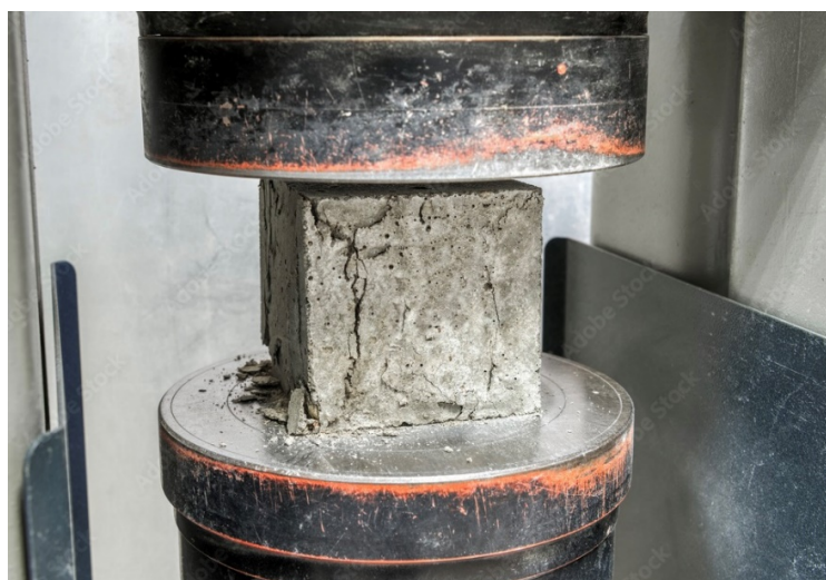
Slika 14: Ispitani uzorak betonske kocke [19]
