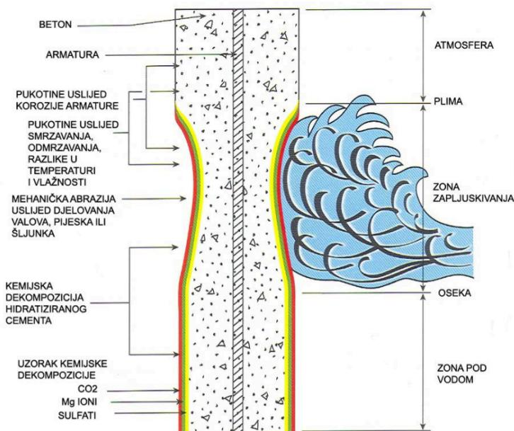
Slika 3: Utjecaj morske vode na armiranobetonski stup [2]
