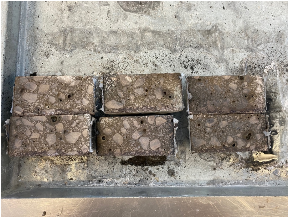
Slika 27: Slomljeni uzorci poprskani srebrnim nitratom (izvor: vlastita fotografija)
