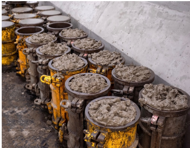
Slika 15: Uzrokovani uzorci u kalupima [20]
