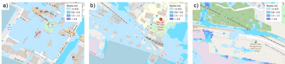
Slika 50: Izdvojena područja povećanog rizika od poplava sa prikazanim dubinama vode (m): a) područje centra grada uz obalu, b) područje Mlake i c) podvožnjak na Kantridi
