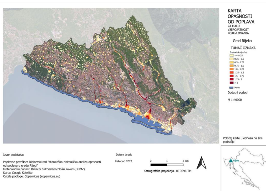
Slika 48: Karta opasnosti od poplava za malu vjerojatnost pojavljivanja s prikazanim brzinama vode (m/s)
