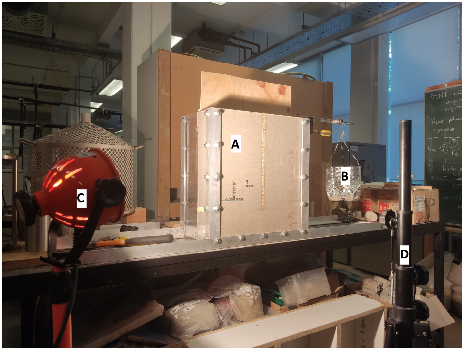
Slika 4.2: Radno okruženje: (a) sanduk, (b) posuda za opterećenje, (c) reflektor i (d) stalak
