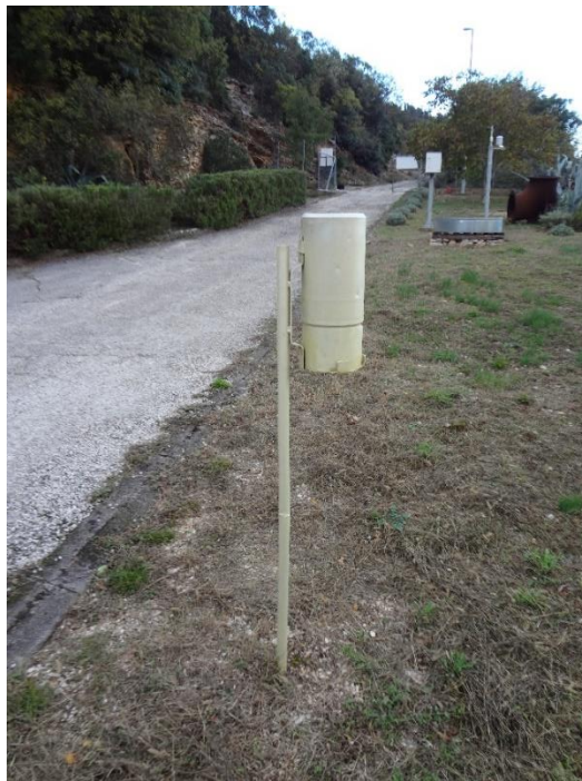
Slika 3.1.4. Kišomjer uz Vransko jezero (izradio autor)
