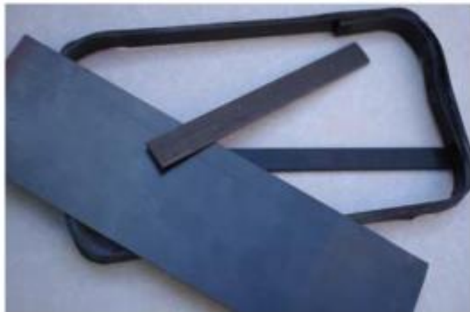
Slika 2: FRP trake i lamele za pojačanje [6]
