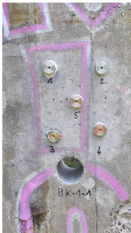
Slika 45 Prikaz pripremljenih mjernih alata za ispitivanje pull off metodom (pozicija B-K-1-1)
