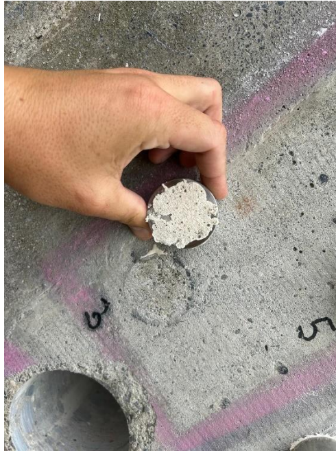
Slika 56 Prikaz sloma prilikom ispitivanja pull off metodom na poziciji B-K-1-1 (ispitni uzorak broj 3)
