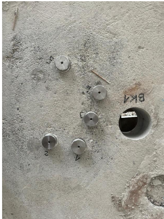
Slika 44 Prikaz pripremljenih mjernih alata za ispitivanje pull off metodom (pozicija B-K-1)
