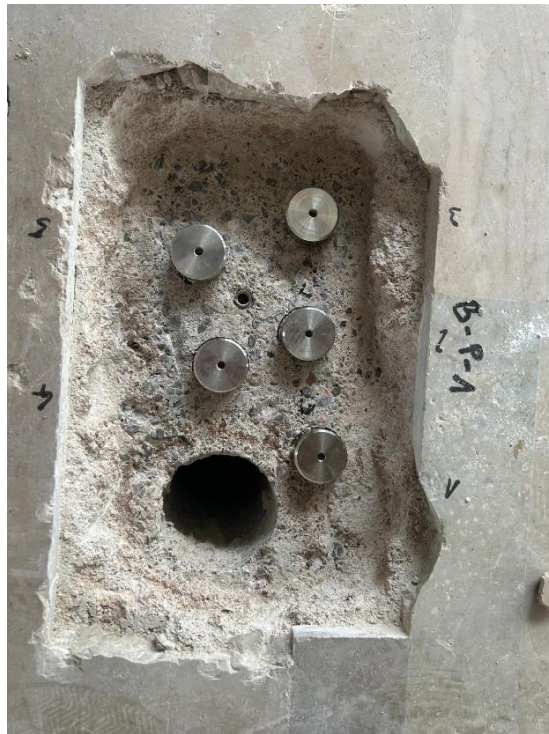
Slika 42 Prikaz pripremljenih mjernih alata za ispitivanje pull off metodom (pozicija B-P-1)
