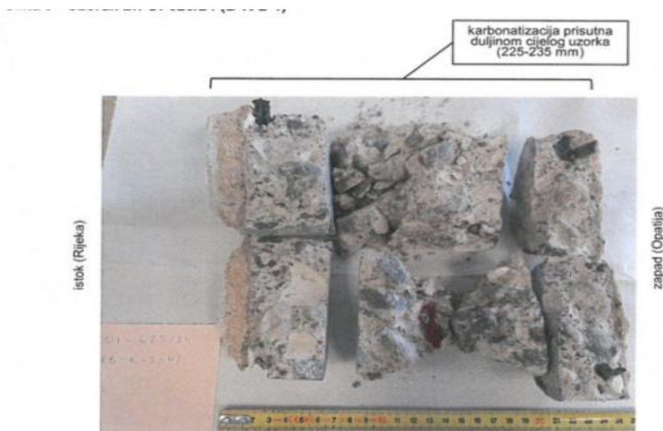
Slika 36 Prikaz prolaska karbonata kroz cijeli ispitani uzorak [11]
