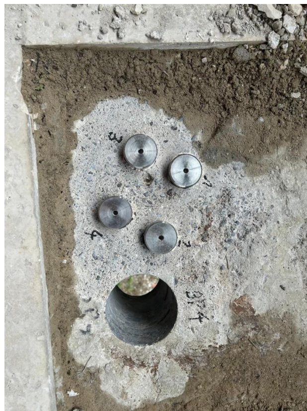
Slika 43 Prikaz pripremljenih mjernih alata za ispitivanje pull off metodom (pozicija B-P-4)
