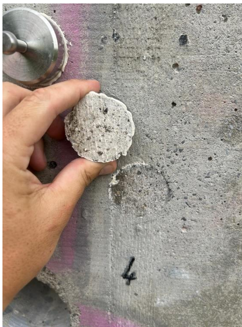
Slika 57 Prikaz sloma prilikom ispitivanja pull off metodom na poziciji B-K-1-1 (ispitni uzorak broj 4)
