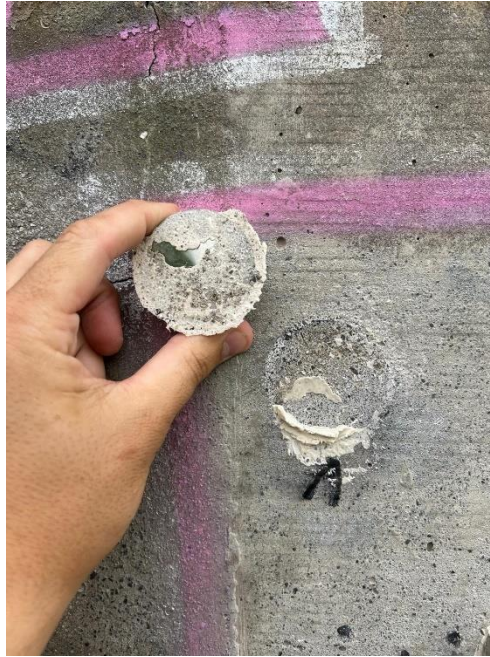
Slika 54 Prikaz sloma prilikom ispitivanja pull off metodom na poziciji B-K-1-1 (ispitni uzorak broj 1)
