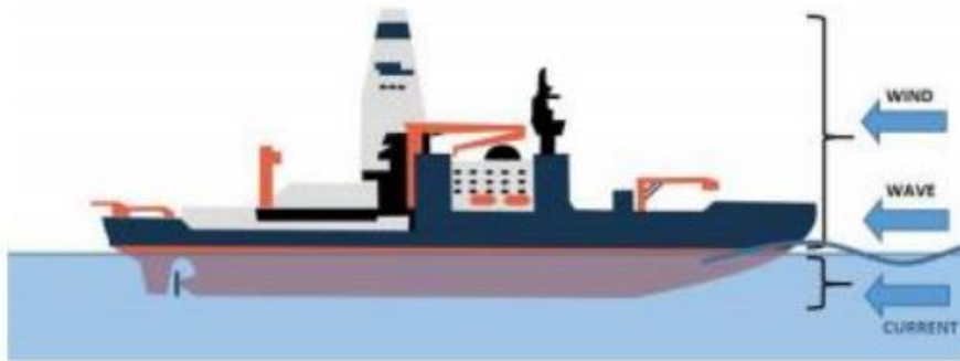
Slika 38: Djelovanje vjetra, valova i morskih struja na plovilo (The Naval Arch, 2017.)
