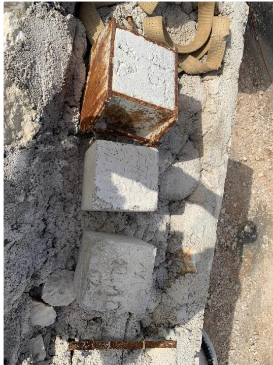
Slika 4: Uzorci kocaka poslani na ispitivanje (fotografirao autor)
