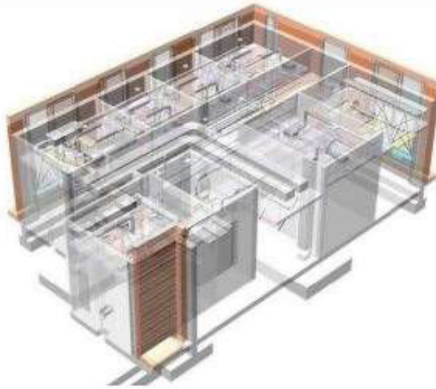
Slika 11: Primjer koordinacijskog modela za arhitektonski i strojarski dio projekta [7]
