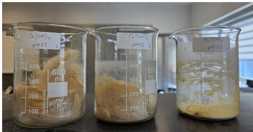
Slika 44: Vunena vlakna \text{Ca}(\text{OH})_2 nakon 56 dana (Autor: Nikolina Edjut)
