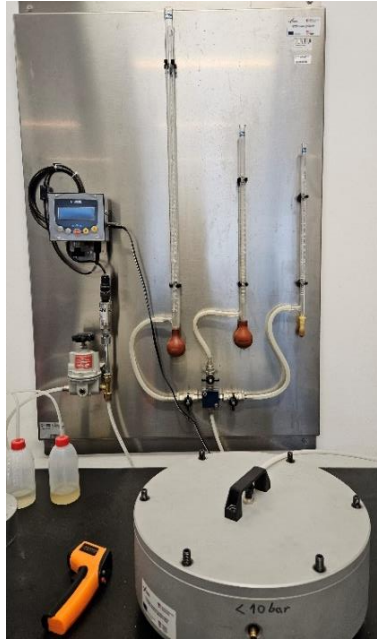
Slika 24. Aparatura za ispitivanje plinopropusnosti: zračna komora, digitalni manometar, mjeraci protoka, sapunica i ventili (Autor: Nikolina Edjut)
