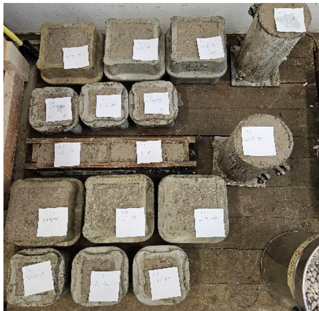
Slika 13. Ugrađene betonske mješavine u kalupe (Autor: Nikolina Edjut)
