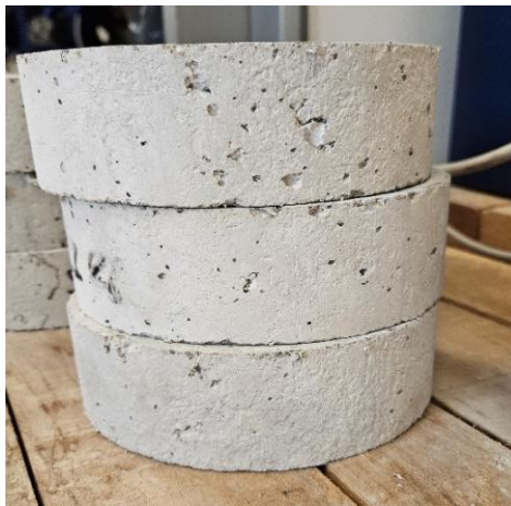
Slika 23. Ispiljeni uzorci spremni za ispitivanje (Autor: Nikolina Edjut)
