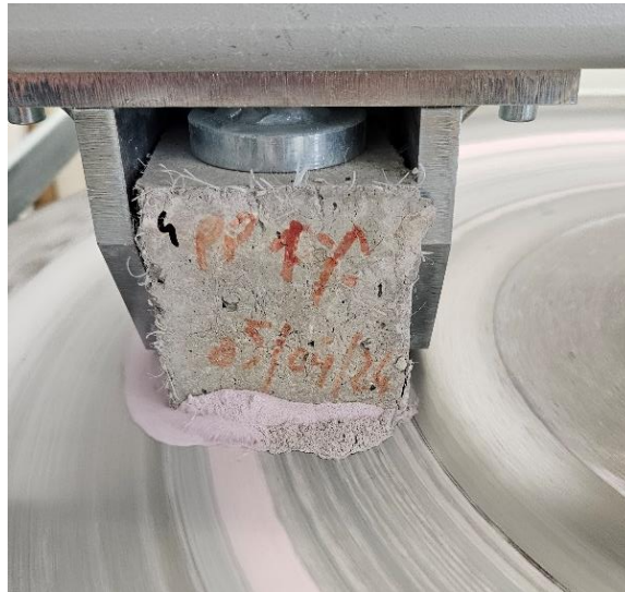
Slika 18.: Uzorak postavljen u kalup za vrijeme rada uređaja (Autor: Nikolina Edjut)
