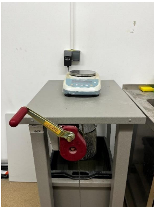
Slika 11: Vaganje zasićenog površinski suhog agregata (izvor: vlastita fotografija)
