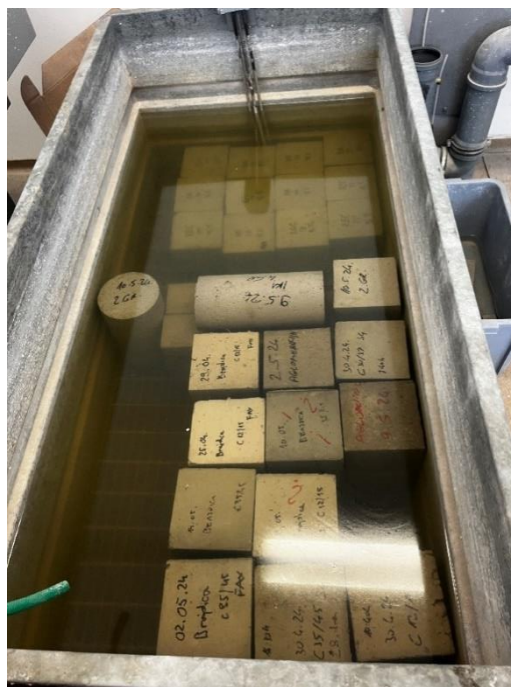
Slika 16: Betonski uzorci zasićeni vodom (izvor: vlastita fotografija)
