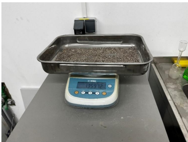
Slika 9: Vaganje potpuno suhog pijeska (izvor: vlastita fotografija)
