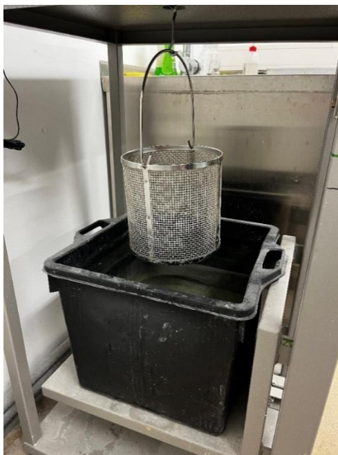
Slika 10: Vaganje agregata na zraku (izvor: vlastita fotografija)
