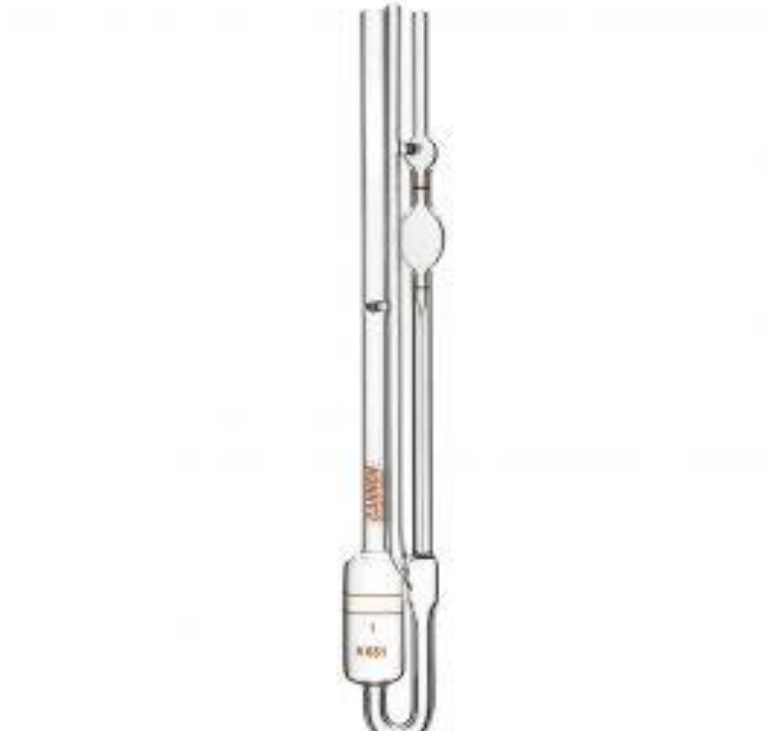
Slika 14. – BS/U cijevni viskozimetar
