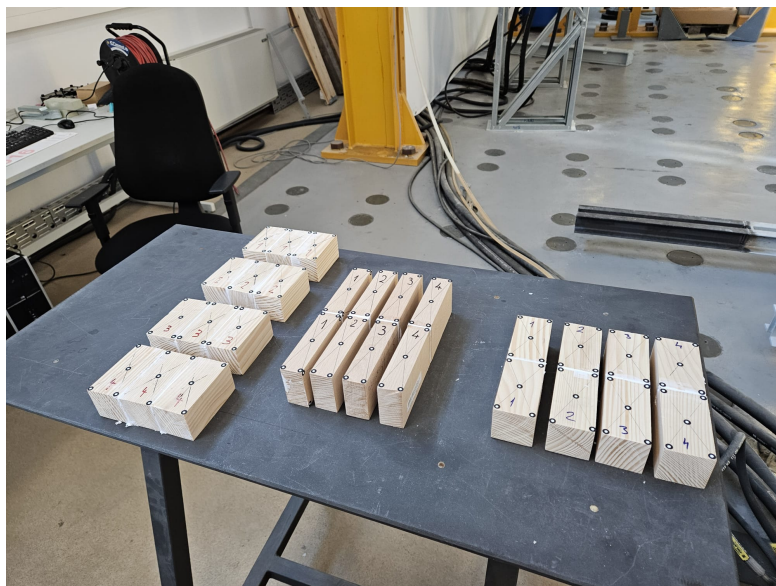
Slika 3.3: Uzorci za ispitivanje na posmik (lijevo), vlak (sredina) i tlak (desno)
