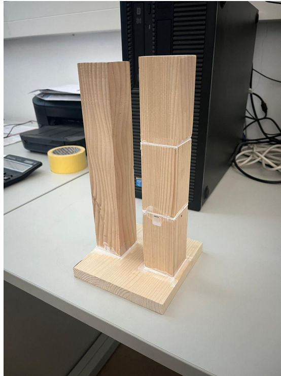
Slika 3.10: Uzorak bloka i podloge za dinamičko istraživanje
