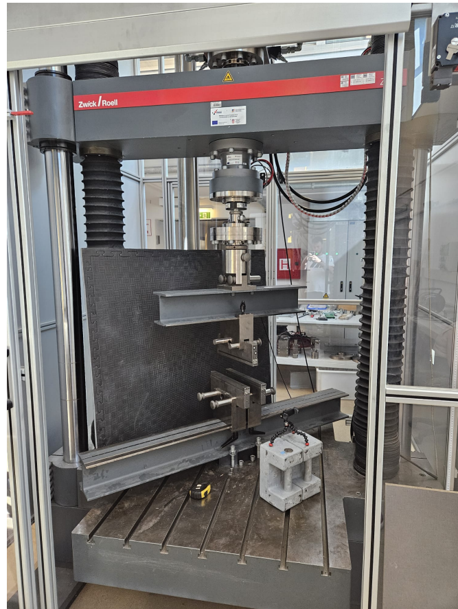
Slika 3.1: Donji radni prostor univerzalnog tlačno-vlačnog stroja (kidalica) Z600 (Zwick/Roell)
