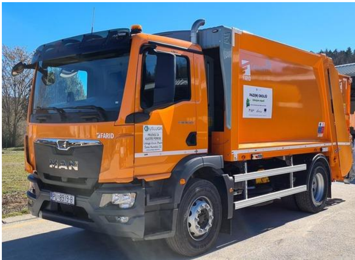
Slika 10. Specijalno komunalno vozilo od min. 14 m 3 za odvojeno prikupljanje otpada [15]
