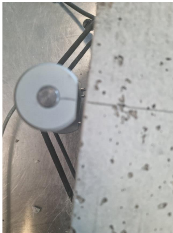
Slika 25: Ekstenzometar pričvršćen na uzorku
