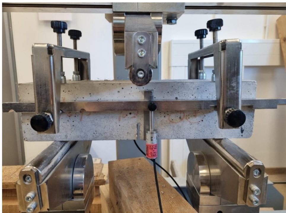
Slika 24: Mjerni uređaj pričvršćen na uzorku
