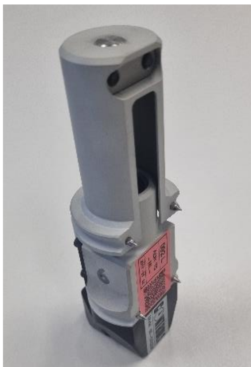
Slika 26: Ekstenzometar s vidljivim konusnim čeličnim vrhovima
