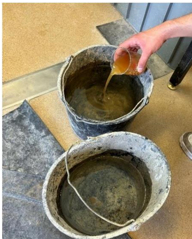
Slika 17: Dodatak superplastifikatora u vodu [14]
