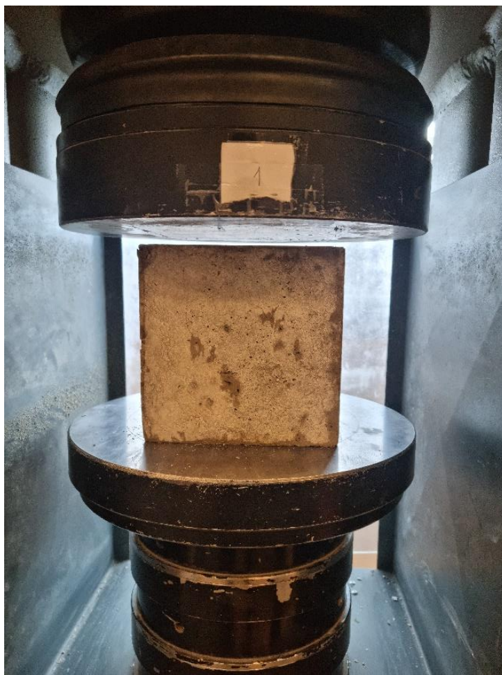
Slika 21: Uzorak pozicioniran u uređaju
