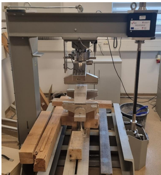
Slika 22: Uređaj za ispitivanje vlačne čvrstoće
