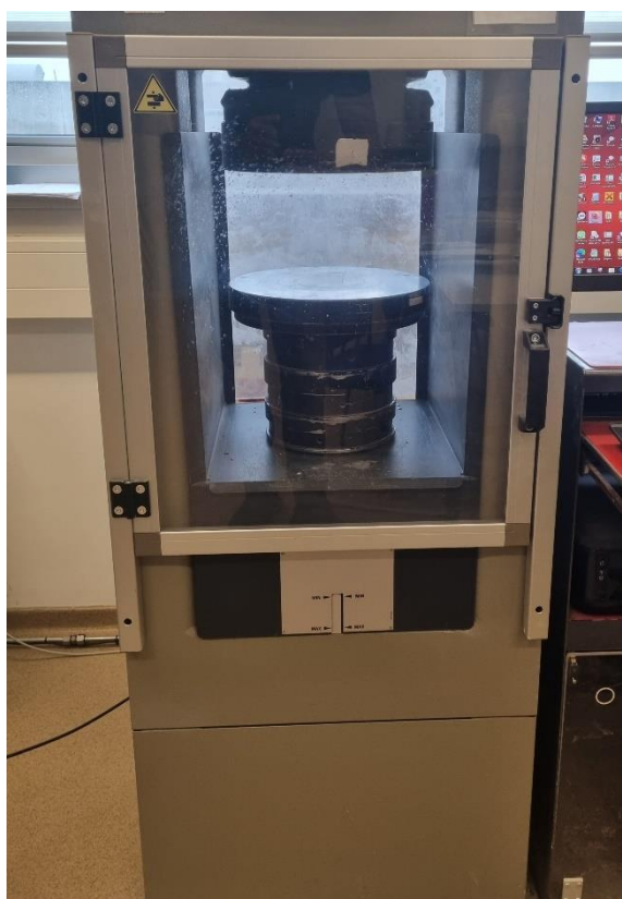
Slika 20: Uređaj za ispitivanje tlačne čvrstoće
