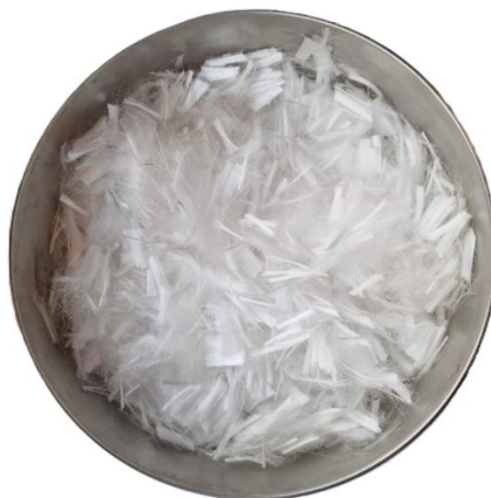
Slika 18: PP vlakna duljine 18 mm
