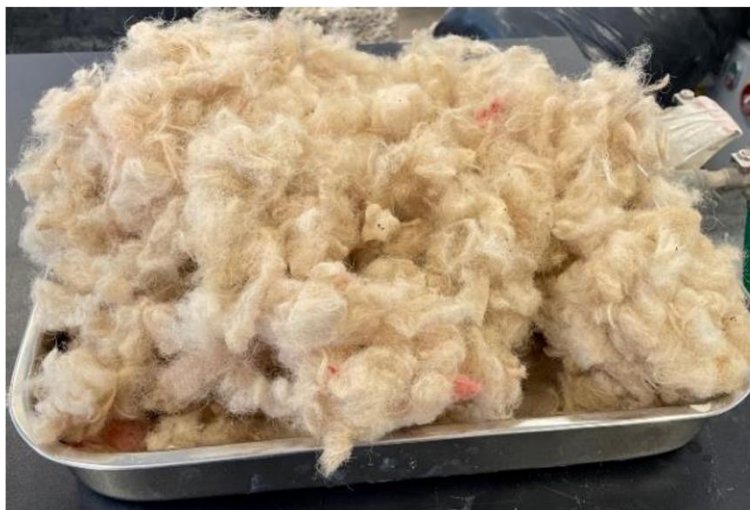
Slika 19: Prirodna vunena vlakna nakon tretiranja i čišćenja [18]
