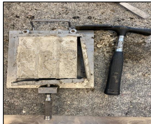
Slika 12. Odvajanje prizmi od kalupa [20]
