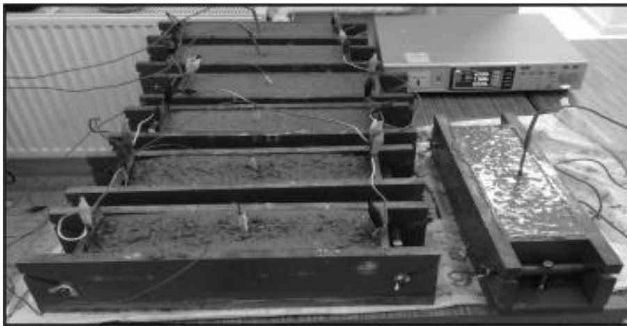
Slika 7. Njega betona korištenjem električne energije[19]
