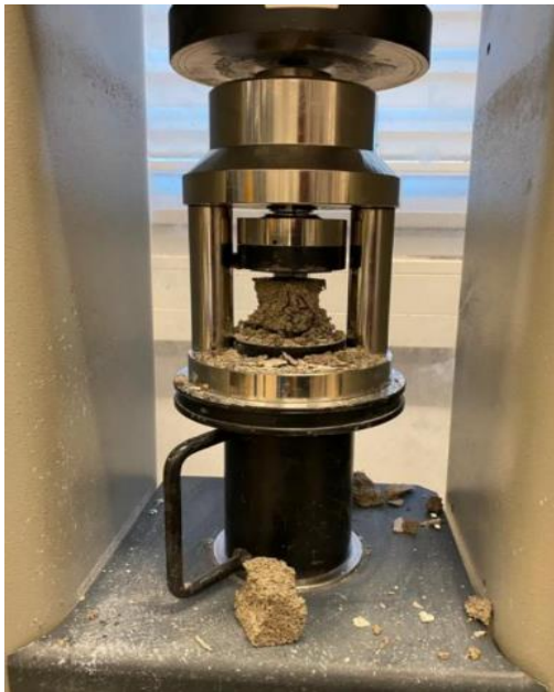
Slika 18. Oblik sloma uzorka nakon tlačnja
