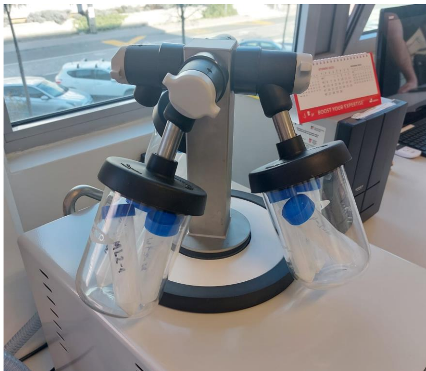
Slika 15. Uzorci na liofilizatoru (autorska fotografija)
