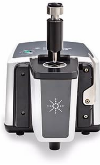
Slika 14. The Cary 630 FTIR Spectrometer [37]
