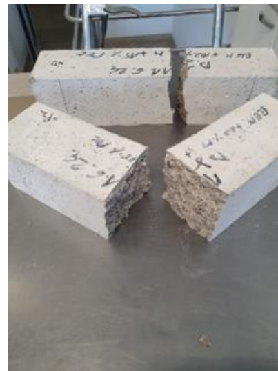
Slika 32. Uzorak s postavljenim senzorima pomaka nakon sloma (lijevo) i uzorak nakon provedenog ispitivanja (desno) (Foto autor)
