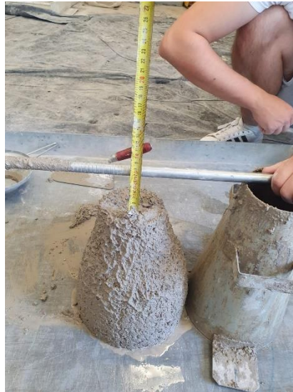
Slika 25. Slijeganje mješavine REF + 10M + 1%PVC (Foto autor)
