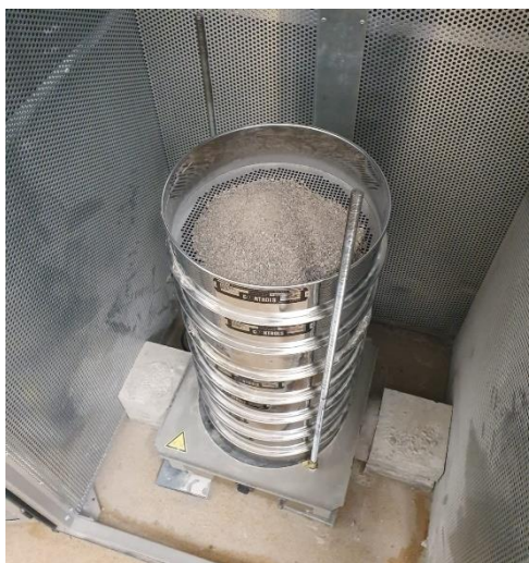
Slika 11. Sijačica za određivanje granulometrijskog sastava (Foto autor)
