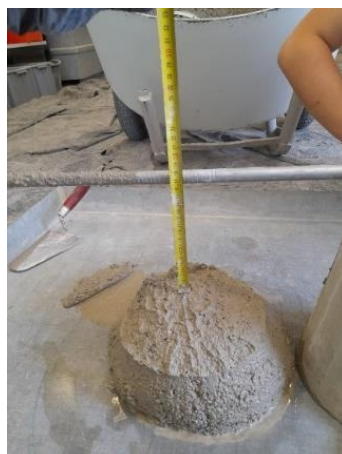
Slika 22. Ispitivanje konzistencije metodom slijeganja (Foto autor)
