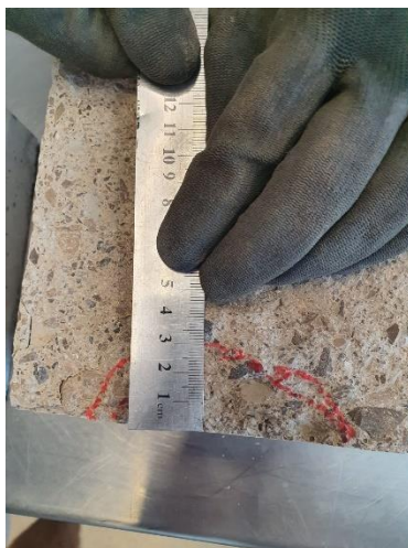
Slika 39. Označena visina prodora vode i njeno mjerenje (Foto autor)
