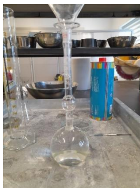
Slika 16. Le Chatelierova tikvica za određivanje gustoće cementa (Foto autor)
