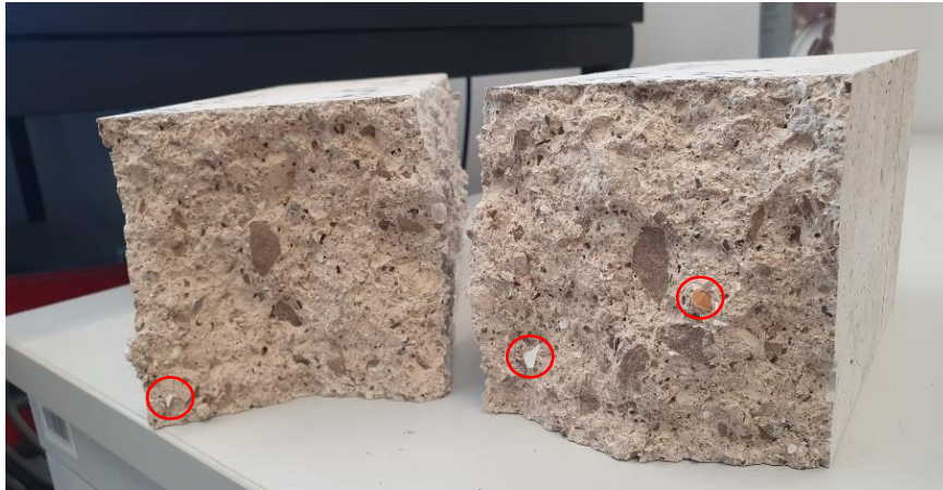
Slika 33. Slomljeni uzorak s 15% PVC-a s označenom PVC piljevinom (Foto autor)
