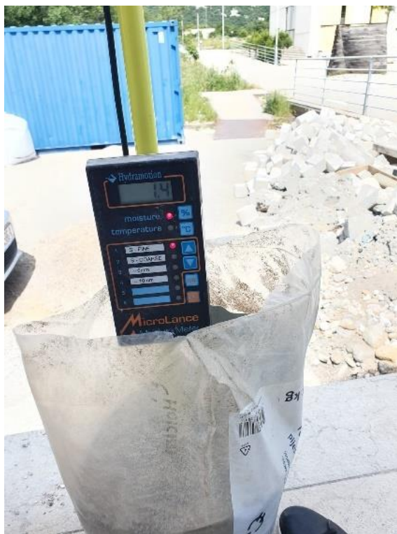
Slika 21. Određivanje vlažnosti agregata u vreći (Foto autor)
