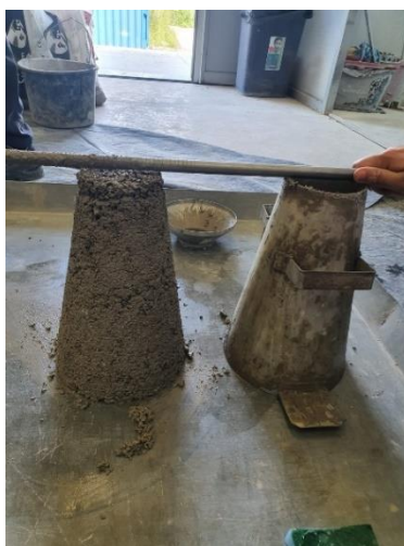
Slika 26. Slijeganje mješavine REF + 10M + 15%PVC (Foto autor)
