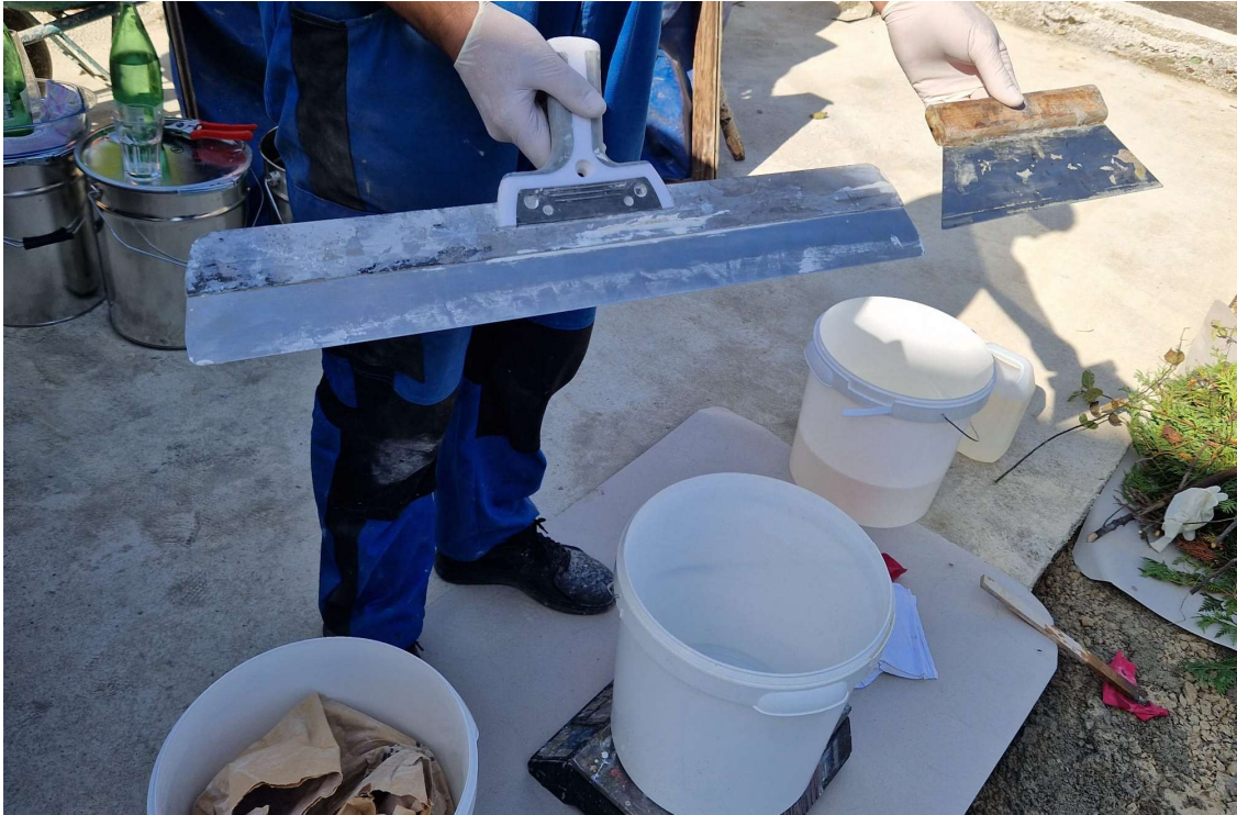
Slika 8: Slika prikazuje špahtlu i gleter sa kojima se smjesa razvlači. (Autor: Anton Bekić)
