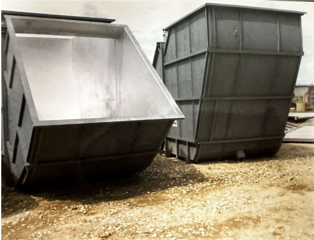
Slika 4: Prikaz dimnjaka sa ugrađenim premazom otpornim na toplinu (Autor: Anton Bekić)
