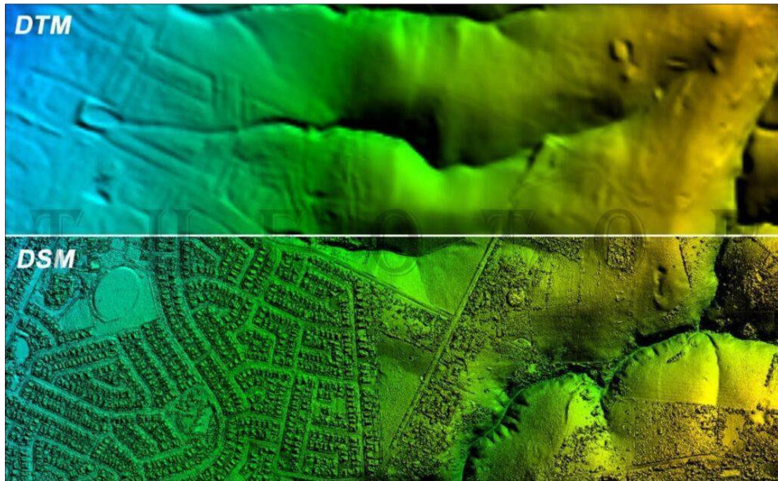
Slika 13. Razlika digitalnog modela reljefa (DTM) I digitalnog modela površine (DSM) [15]
