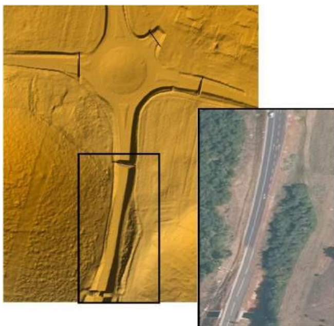
Slika 27. Korekcija DMT-a zbog propusta
