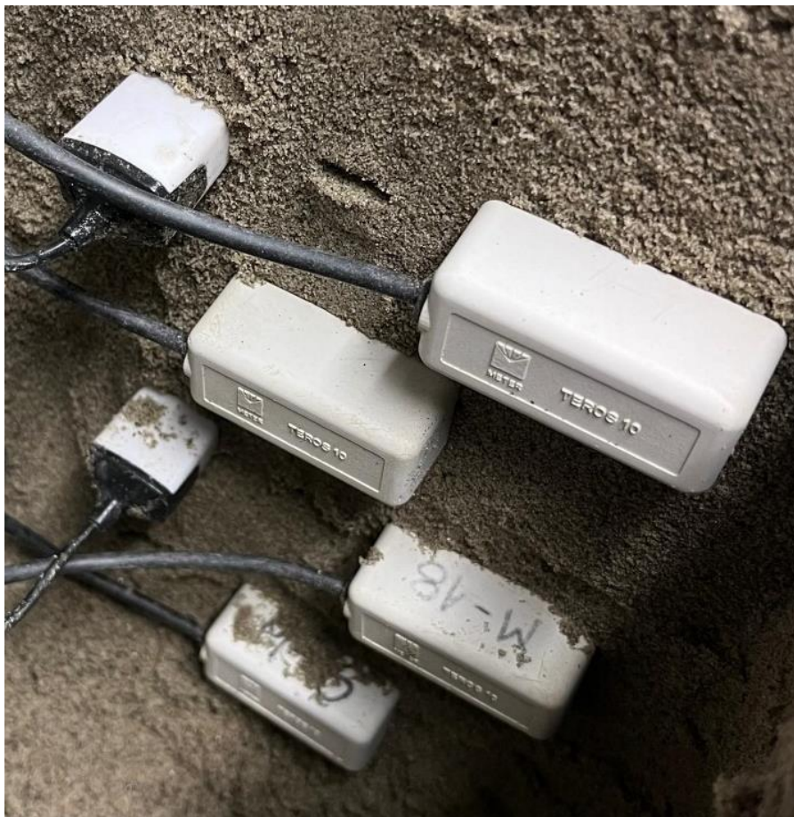
Slika 17: Ugrađeni senzori u gornjoj (H) zoni
