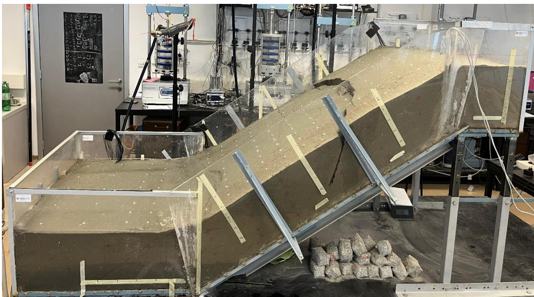
Slika 32: Bočni prikaz sloma kosine
