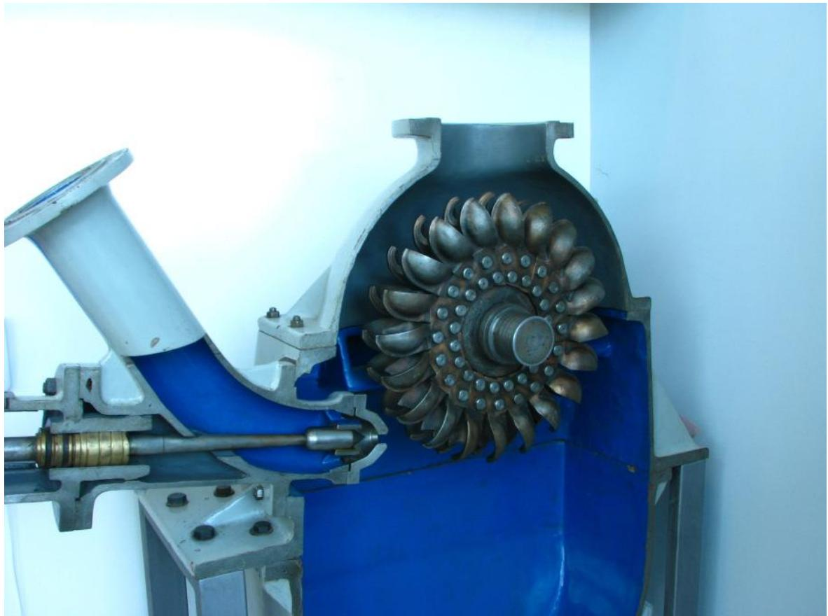
Slika 13: Turbina: Peltonova [4]
