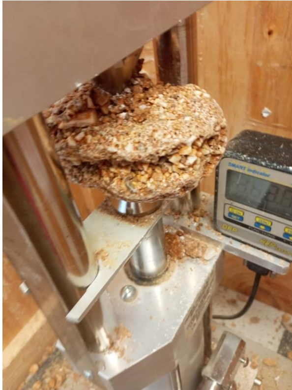
Slika 33: Probijanje uzorka, primjer odbačenog pokusa
