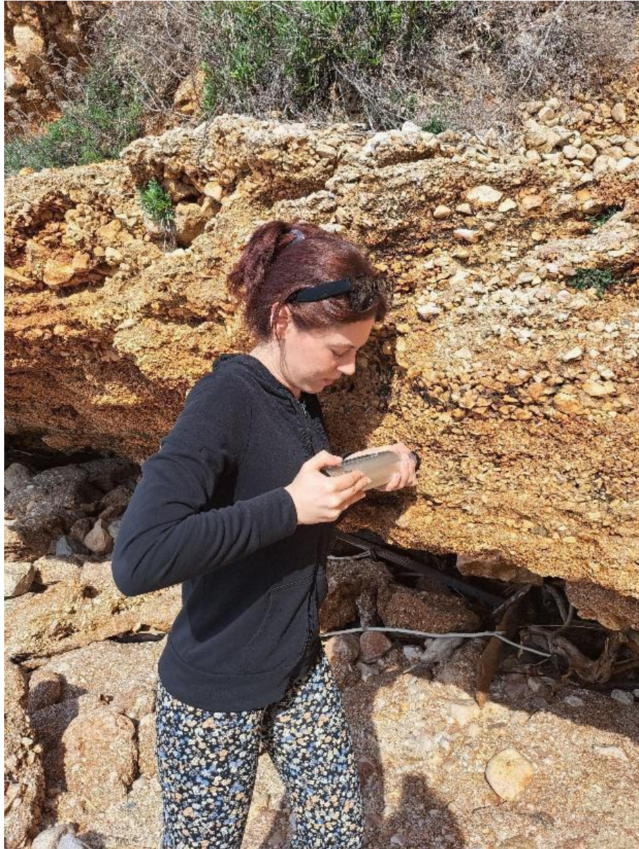
Slika 15: Ispitivanje stijenske mase Shmitovim čekićem, Lokacija 1, trošna stijena
