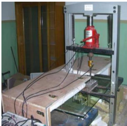
Slika 13: Uređaj za provođenje testa i termalna kutija
