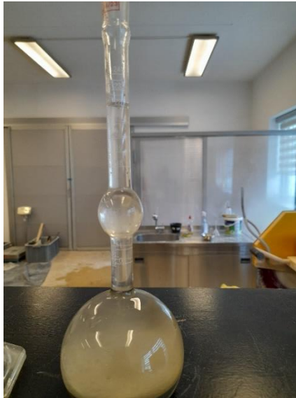
Slika 13: Ispitivanje gustoće cementa pomoću Le Chatelierove tikvice [foto autor]
