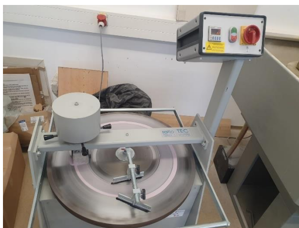
Slika 30: Stroj za ispitivanje otpornosti na habanje [foto autor]
