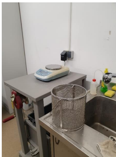
Slika 10: Uređaj za vaganje pod vodom [foto autor]
