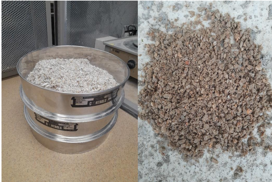
Slika 16: Zrna PVC piljevine (lijevo) i pijeska (desno) [foto autor]
