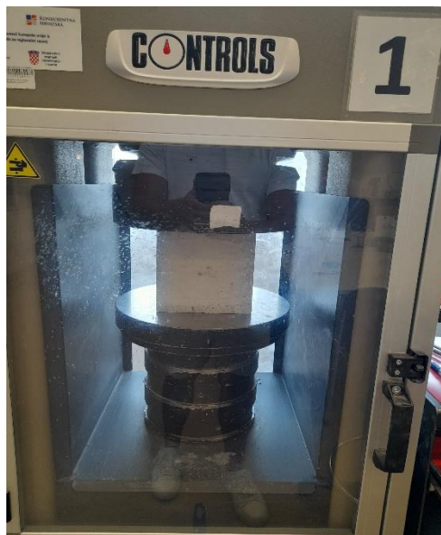
Slika 23: Preša za ispitivanje tlačne čvrstoće [foto autor]
