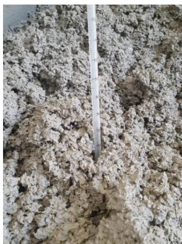
Slika 18: Mjerenje temperature mješavine termometrom [foto autor]
