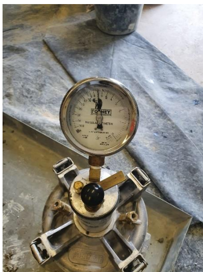
Slika 21: Ispitivanje sadržaja pora porometrom [foto autor]
