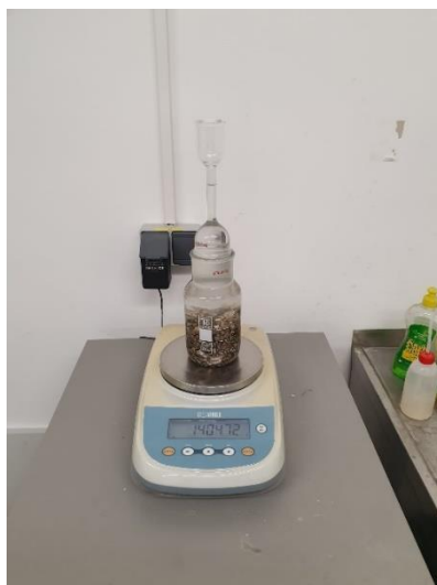
Slika 12: Piknometar ispunjen s vodom i pijeskom [foto autor]
