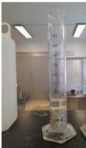
Slika 17: Određivanje gustoće PVC piljevine [foto autor]
