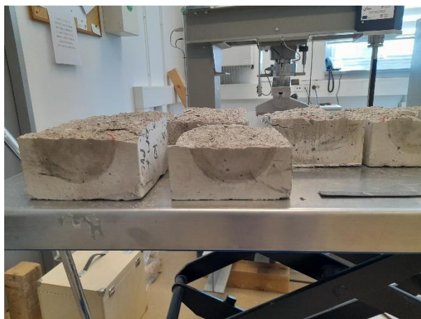
Slika 28: Slom kocke cijepanjem REF+10M+1%PVC [foto autor]
