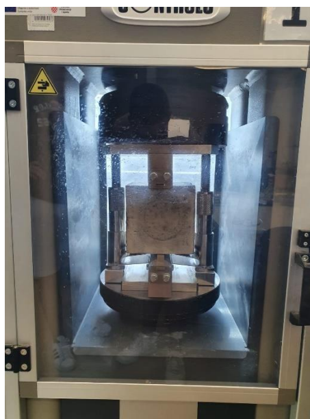
Slika 27: Uređaj za ispitivanje vlačne čvrstoće cijepanjem [foto autor]
