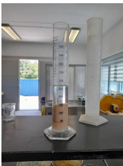
Slika 14: Ispitivanje gustoće metakaolina [foto autor]
