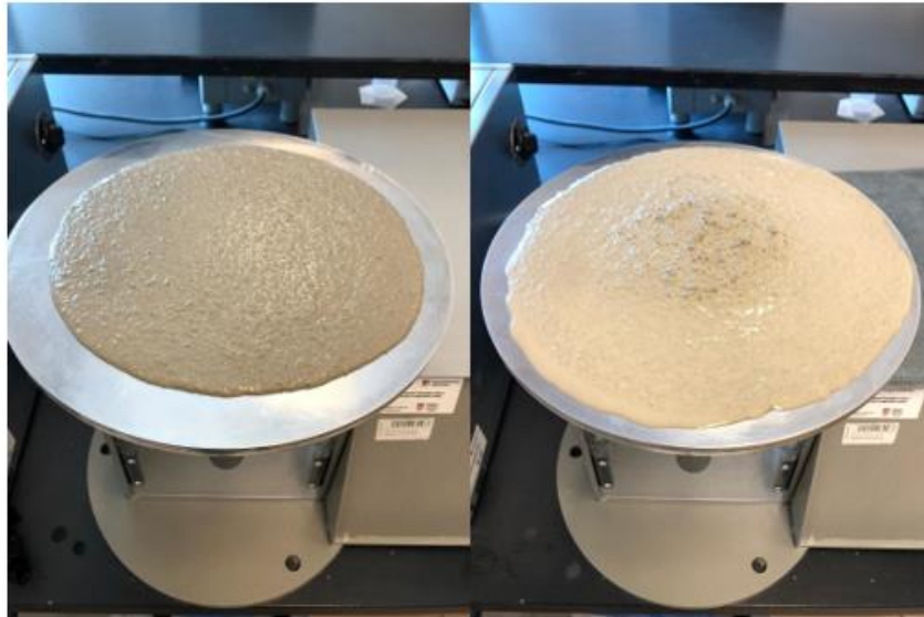
Slika 23. Usporedba konzistencije rasprostiranjem mješavine 0,5% SP (lijevo) i 1% SP (desno)
