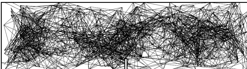
(e) konačni elementi vlakana za model s udjelom vlakana od 75 \text{ kg/m}^3 betona ( V_f=0.975 \% )
