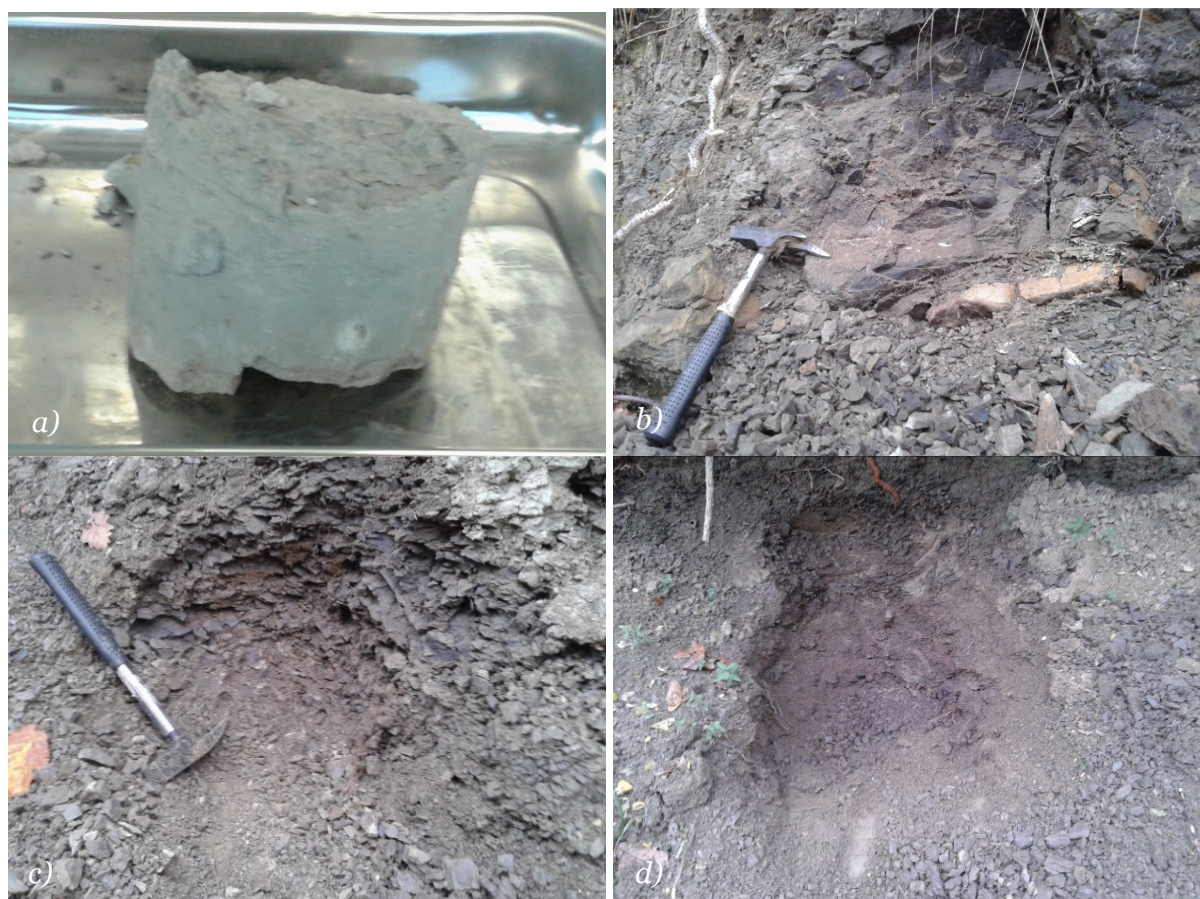
Slika 4.7 Uzorkovanje sitnozrnastih litoloških članova fliša: a) I (FR) stupnja trošnosti iz jezgre bušotine i b) II (SW), c) III/IV (MW/HW), d) IV/V (HW/CW) stupnja trošnosti na izdancima flišne stijenske mase u dolini Rječine
