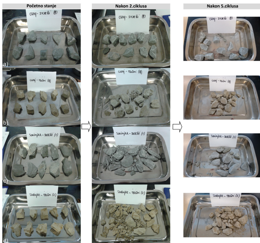
Slika 4.51 Uzorak flišne stijenske mase u početnom stanju (lijevo), nakon drugog ciklusa (sredina) i nakon petog ciklusa (desno) ispitivanja postojanosti (SDT): a) I (FR) stupnja trošnosti (3), b) III (MW) stupnja trošnosti (4), c) I (FR) stupnja trošnosti (1), d) III (MW) stupnja trošnosti (2)
