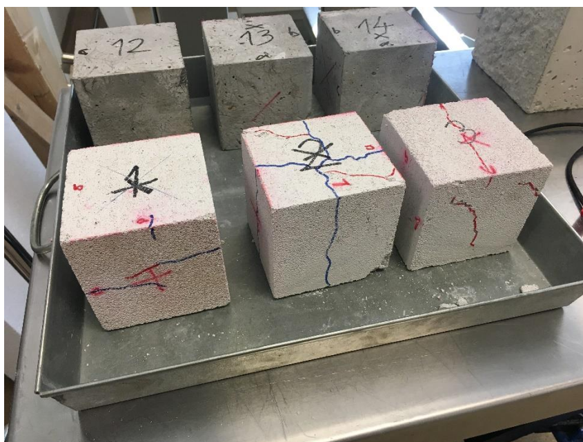
Slika 35: Označene pukotine nakon ispitivanja tlačne čvrstoće betona
