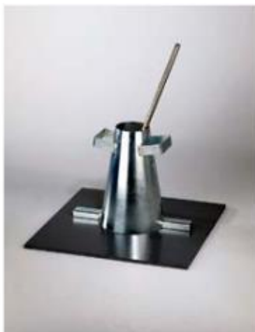
Slika 7: Kalup za ispitivanje slijeganja betona
