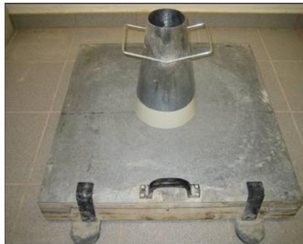
Slika 12: Oprema za ispitivanje rasprostiranja svježeg betona
