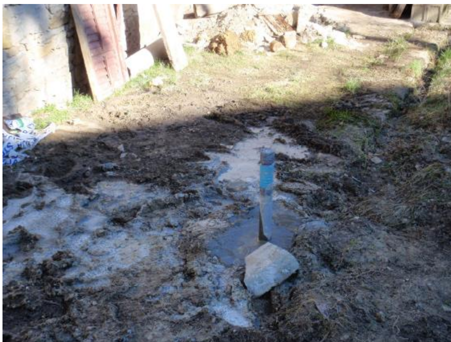
Slika 31. Bušotina B-4 i u nju ugrađen inklinometar (preuzeto iz Bernat, 2011).
