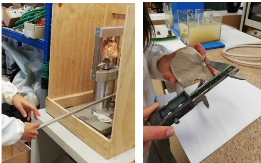
Slika 15: Nanošenje sile na uzorak i mjerenje dimenzija uzorka nakon sloma
