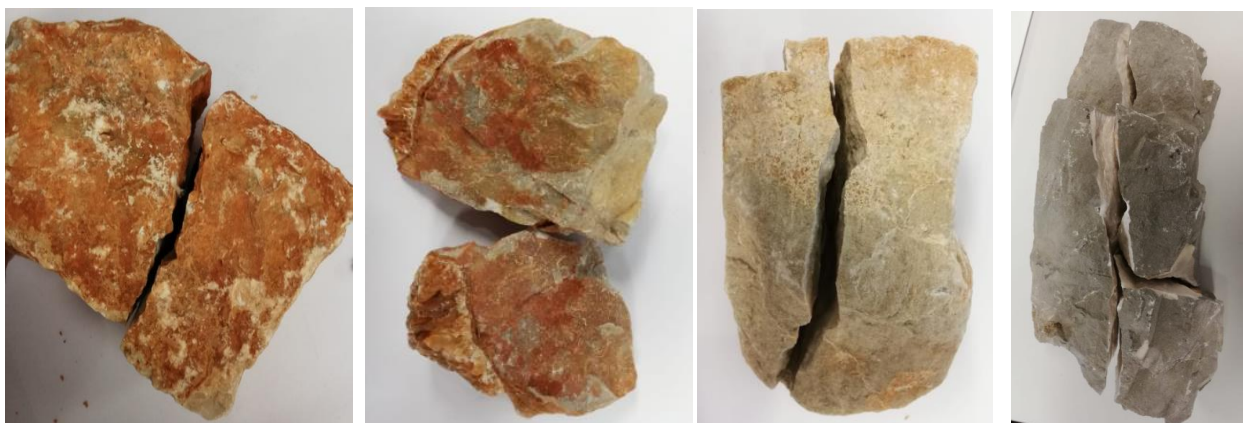
Slika 22: Odabrani uzorci nakon sloma prilikom PLT ispitivanja
