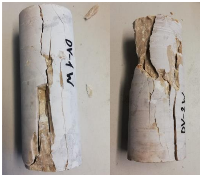
Slika 24: Uzorci 1 i 2 nakon jednoosnog tlačnog ispitivanja u preši
