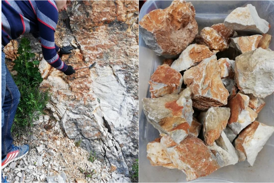
Slika 9: Vapnenci s lokacije 1: a) Munsell ljestvica boja za lokaciju 1, b) stijena ispitana na terenu geološkim i Schmidtovim čekićem, c) odlomci vapnenca korišteni u PLT ispitivanju.
