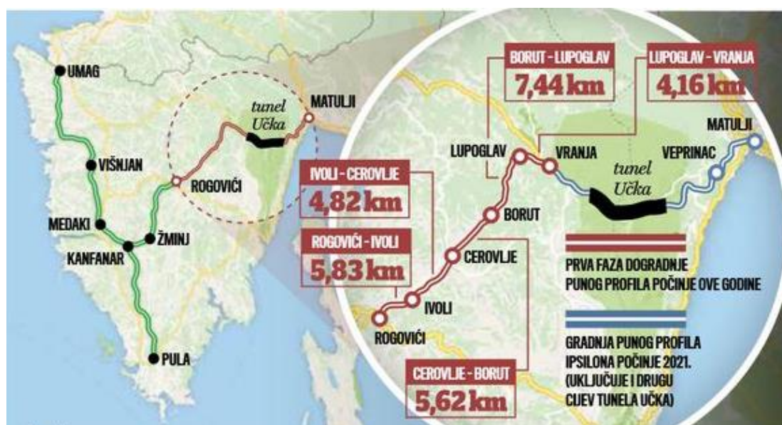
Slika 27: Prikaz Istarskog ipsilona lijevo te prikaz faze trenutne izgradnje desno [31]
