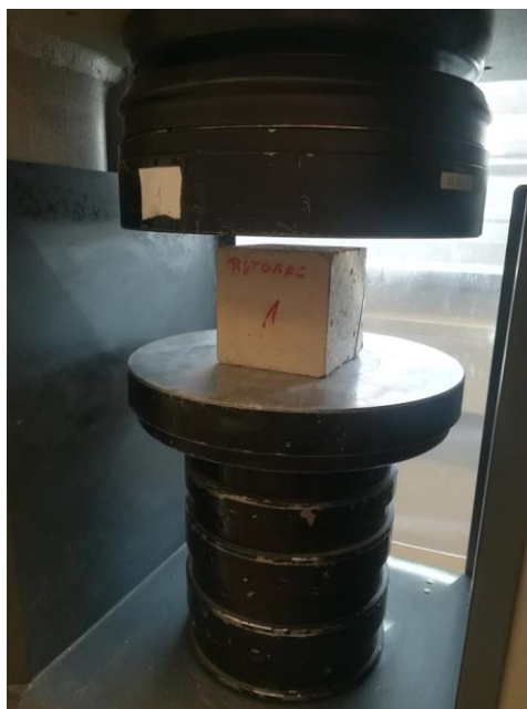
Slika 8 : Ispitivanje tlačne čvrstoće na uzorku kocke
