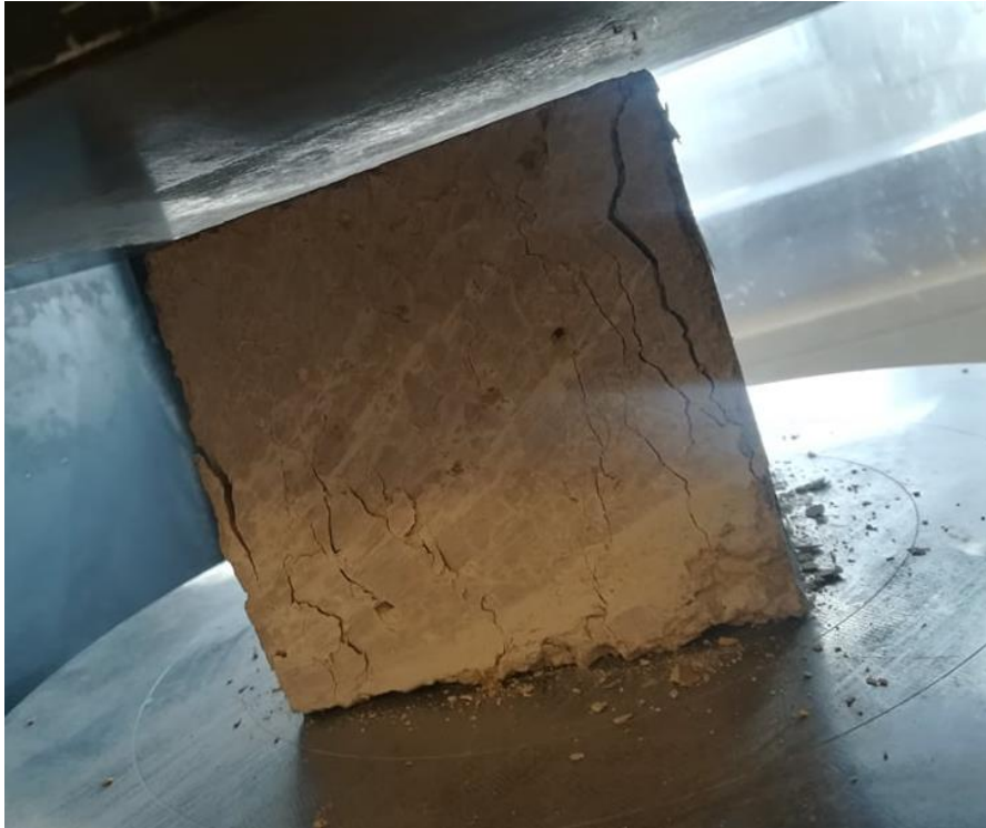
. Slika 20: Oštećenja nakon pojave sloma
