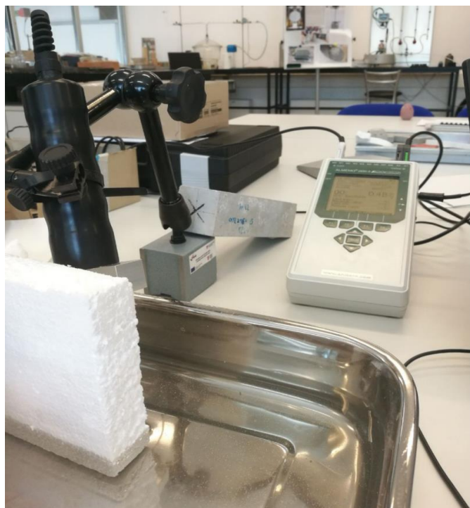
Slika 23: Mjerenje vlažnosti na uzorku stirodura [Ines Šoić]
