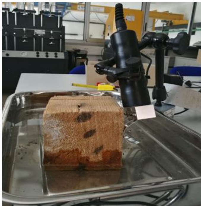
Slika 17: Mjerenje vlažnosti na uzorku drva [Ines Šoić]
