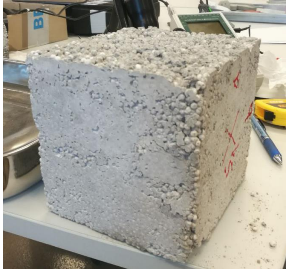
Slika 31: Uzorak stiroporbetona (uzorak 1)[Ines Šoić]
