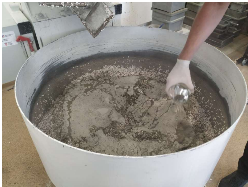
Slika 18: Dodavanje cementa i ostatka vode
