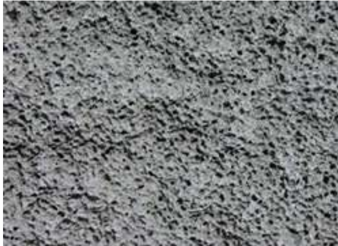
Slika 3: Struktura ćelijastog betona, [5]
