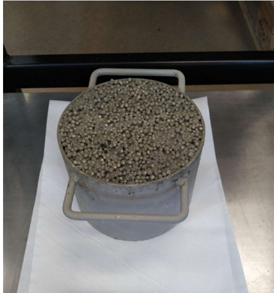
Slika 14: Određivanje gustoće svježeg betona uz pomoć normirane posude
