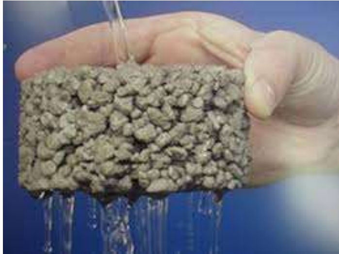
Slika 1: Struktura lakog betona od jednozrnatog materijala,[4]
