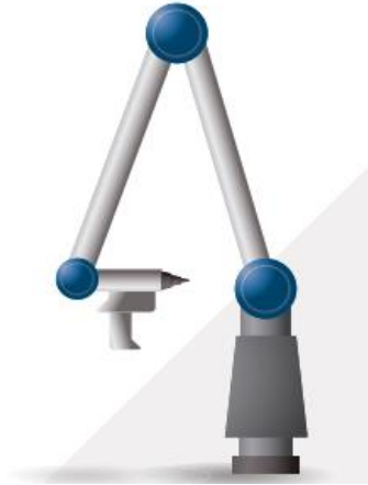
Slika 4. Prikaz zglobne ruke na koju je pričvršćena kontaktna sonda
