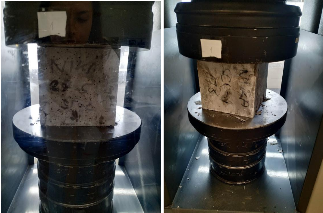
Slika 23: Uzorak prije nanošenja opterećenja (lijevo)
