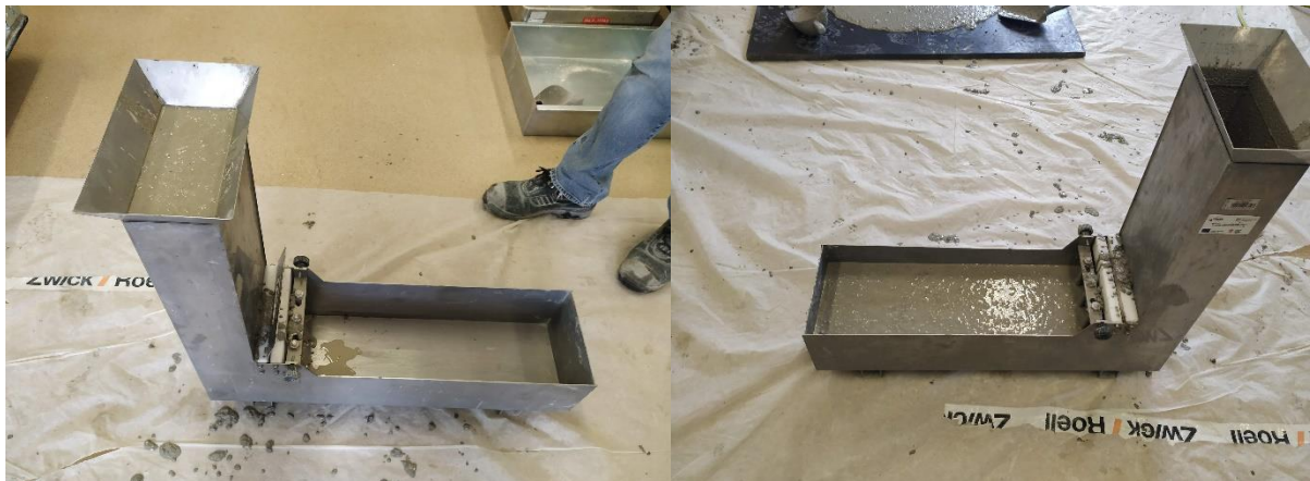
Slika 17: Vertikalni dio L-kutije ispunjen betonom (lijevo)
