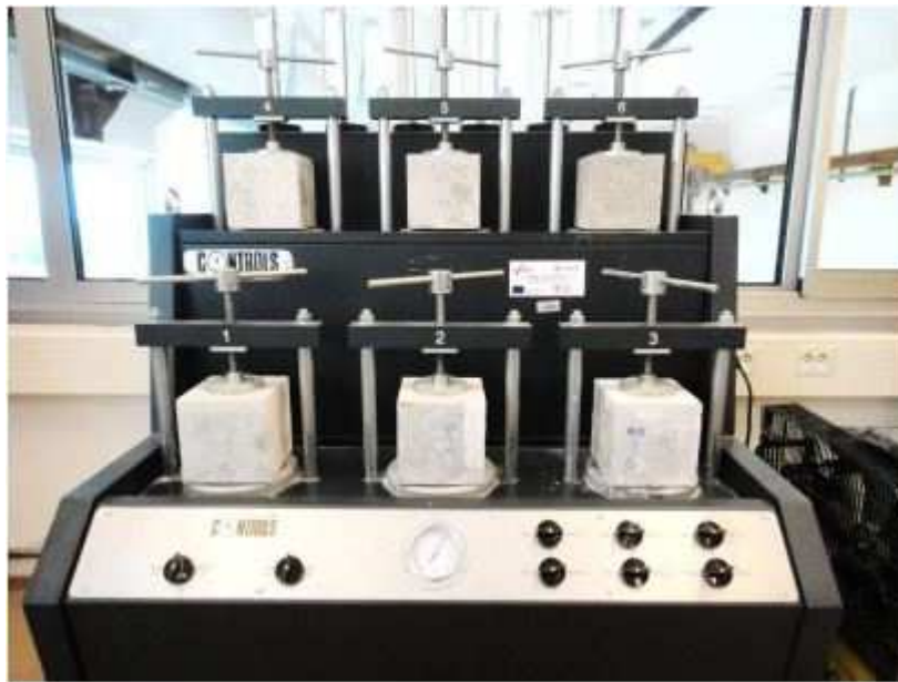
Slika 12. Uređaj za ispitivanje vodopropusnosti [6]
