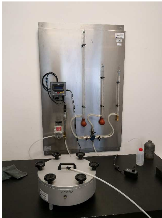
Slika 13. Uređaj za ispitivanje plinopropusnosti
