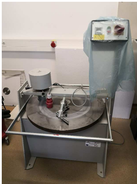
Slika 17. Uređaj za ispitivanje otpornosti na abraziju
