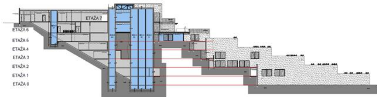
Slika 85. Presjek kroz dizala u središnjem dijelu, 2013.
