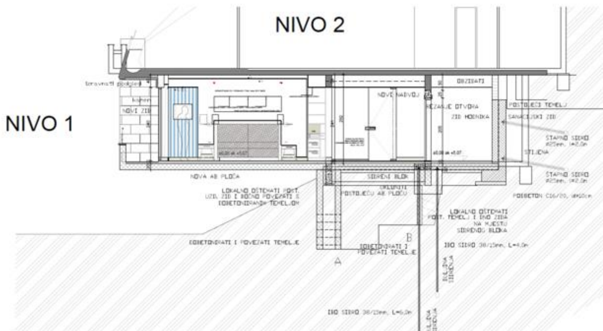
Slika 105. Presjek konzolne sobe, 2013.
