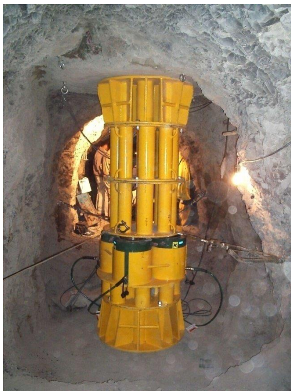
Slika 8 Ispitivanje deformabilnosti metodom "Plate jacking test" PJT (Rezaei, Ghafoori and Ajalloeian, 2016)
