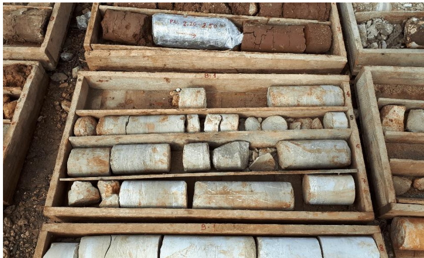
Slika 25 Primjer fotografije jezgre iz bušotina (Geotech d.o.o., 2020)
