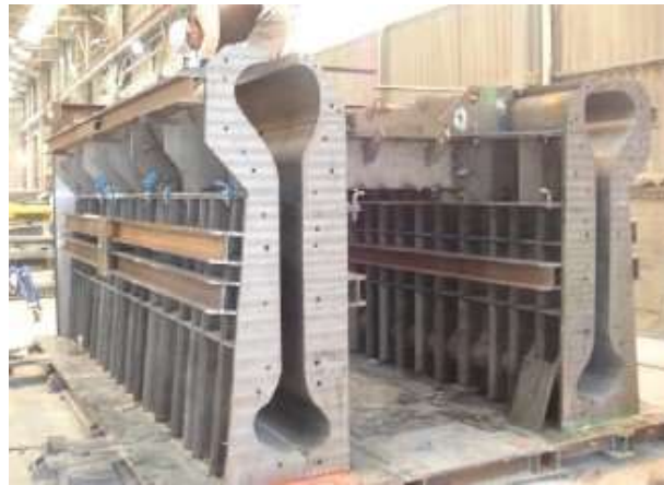
Abbildung 2.33: Ansicht der Schalung [38]
