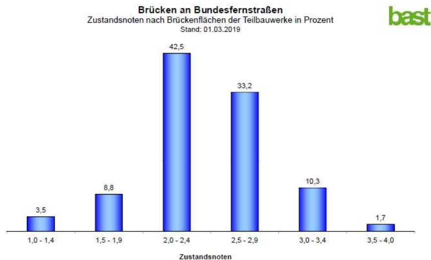
Abbildung 2.7: Zustandsnoten nach Brückenfläche [10]. Note nach Punktzahl: sehr gut (1.0-1.4), gut (1.5-1.9), befriedigend (2.0-2.4), ausreichend (2.5-2.9), nicht ausreichend (3.0-3.4), ungenügender Zustand (3.5-4.0)
