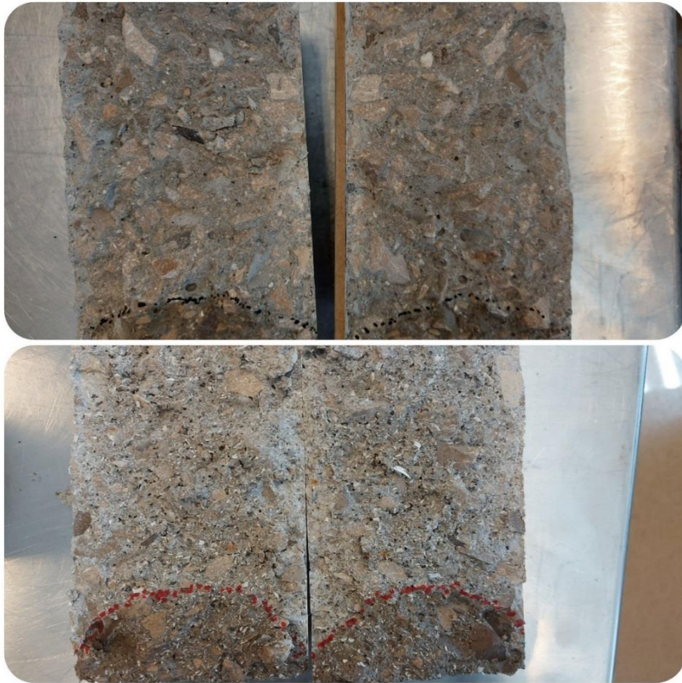
Slika 56: Trag prodora vode na referentnom betonu (gornja slika) i betonu sa 15% PVC-a (donja slika)
