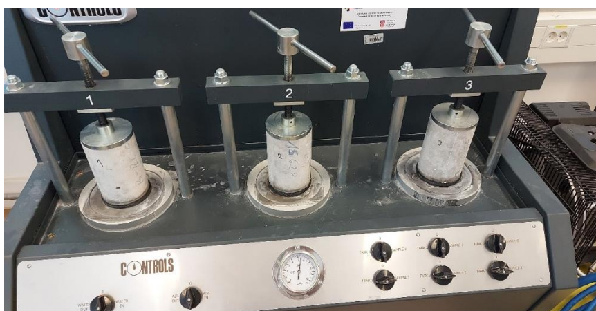
Slika 52: Uzorci referentnog betona izloženi prodoru vode pod tlakom
