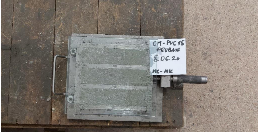
Slika 38: Cementni mort nakon ugradnje u kalup
