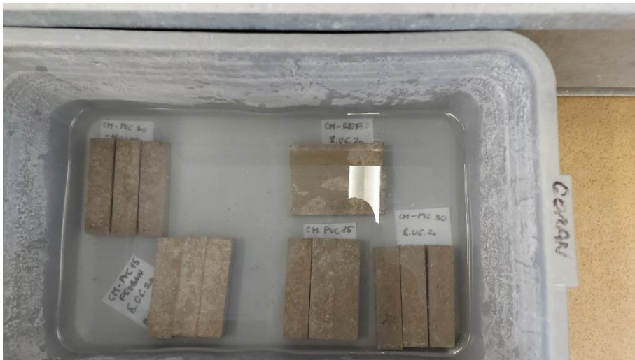
Slika 39: Cementne prizme potopljene u vodi
