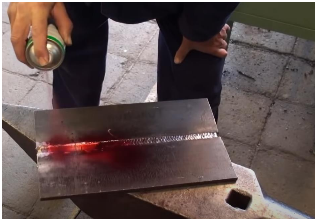
Slika 31: Postupak nanošenja crvenog penetranta [28]
