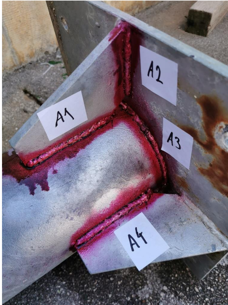
Slika 33: Uzorak A nakon nanošenja penetranta
