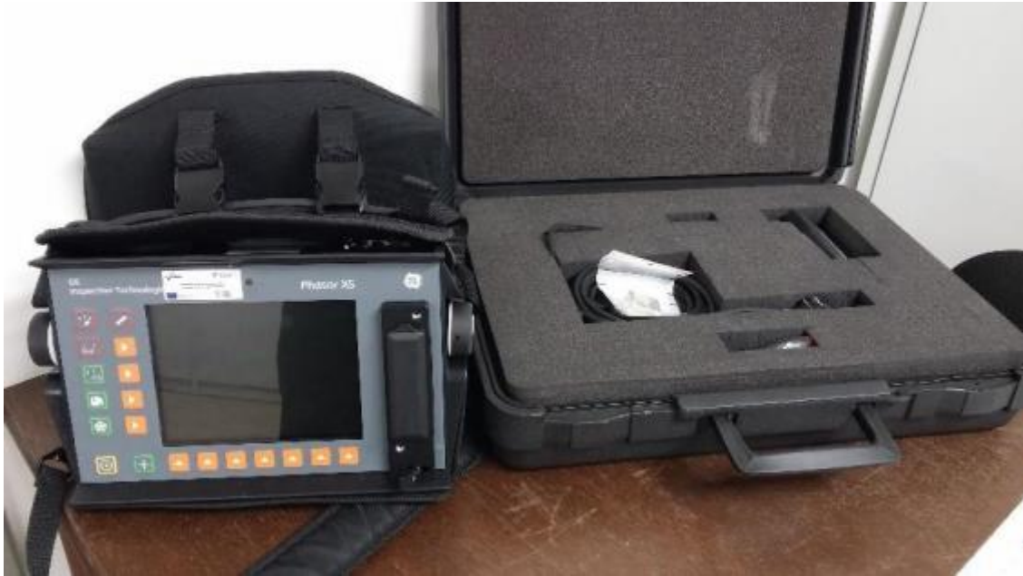
Slika 47: Ultrazvučni uređaj Phasor XS [29]
