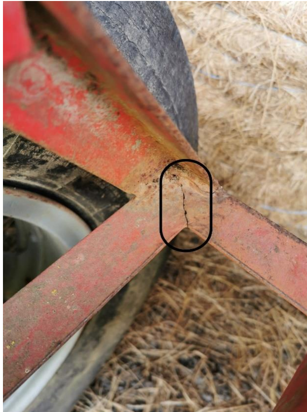
Slika 9: Uočavanje pukotina vizualnom kontrolom (Izradio autor)
