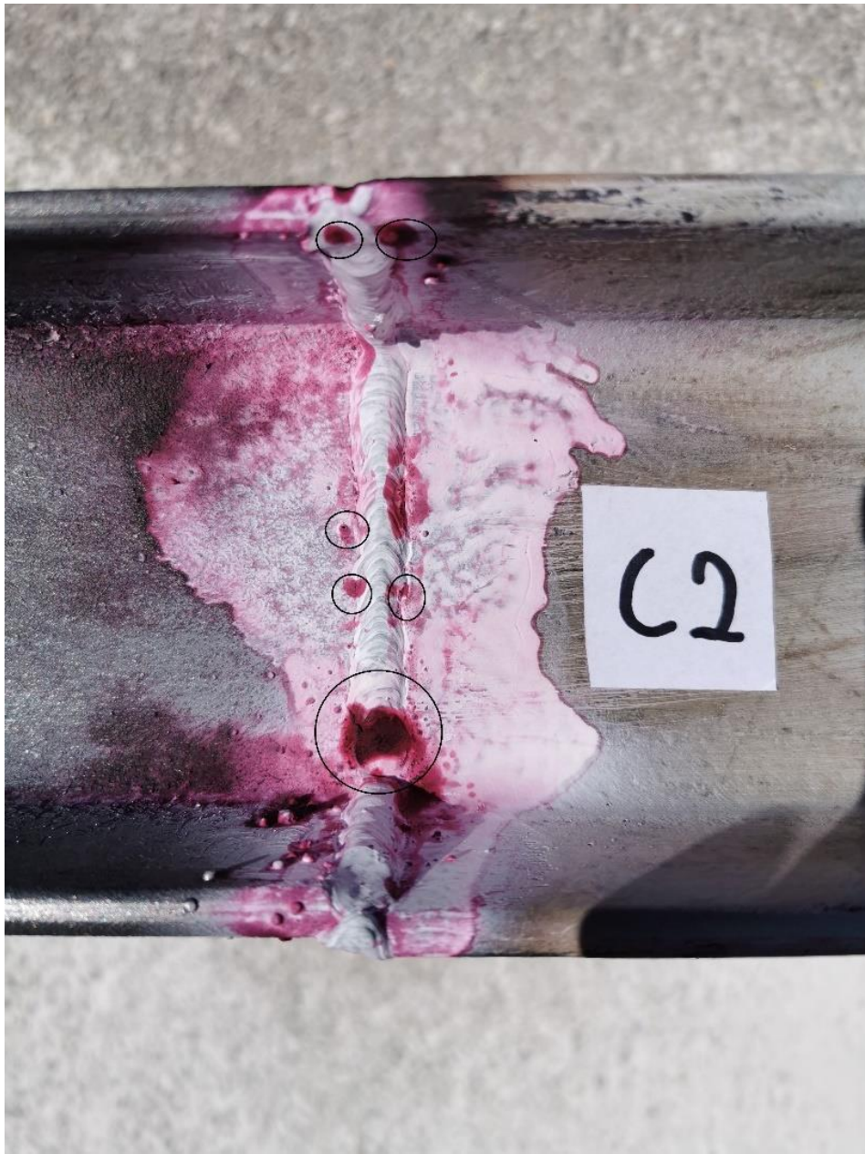
Slika 43: Pukotine na zavaru C2 (Izradio autor)
