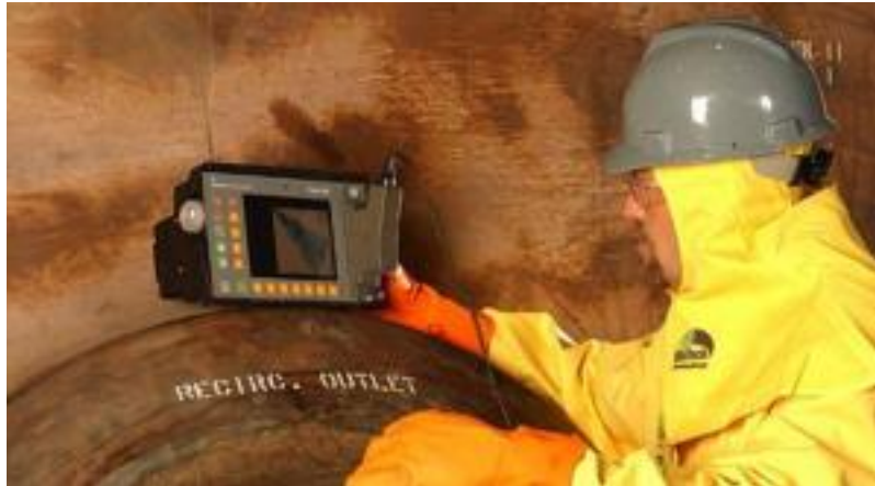
Slika 18: Primjer ultrazvučnog ispitivanja [18]
