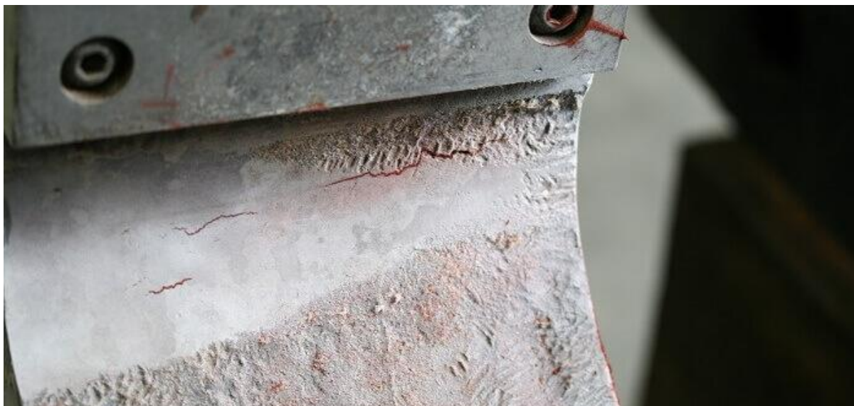
Slika 12: Indikacija pukotine magnetnim česticama [14]
