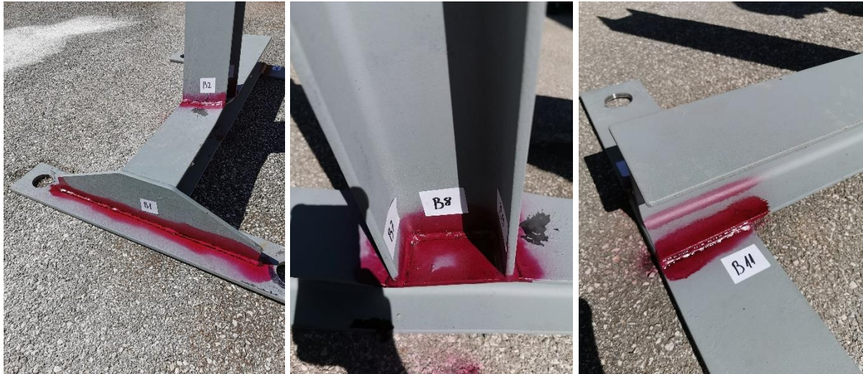
Slika 36: Uzorak B s nanesenim penetrantom (Izradio autor)
