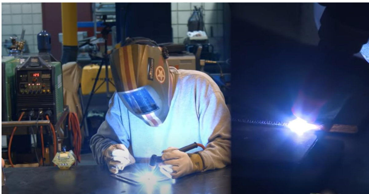
Slika 7: Proces zavarivanja sučelnog zavora [5]
