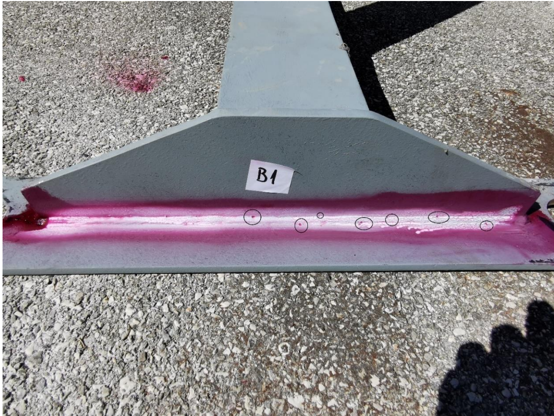
Slika 38: Poroznost kod zavora B1 (Izradio autor)
