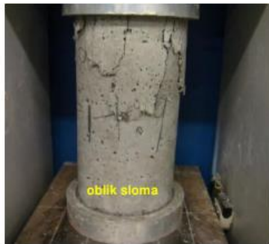
Slika 2, Ispitivanje betonskog uzroka valjka na tlak [8]
