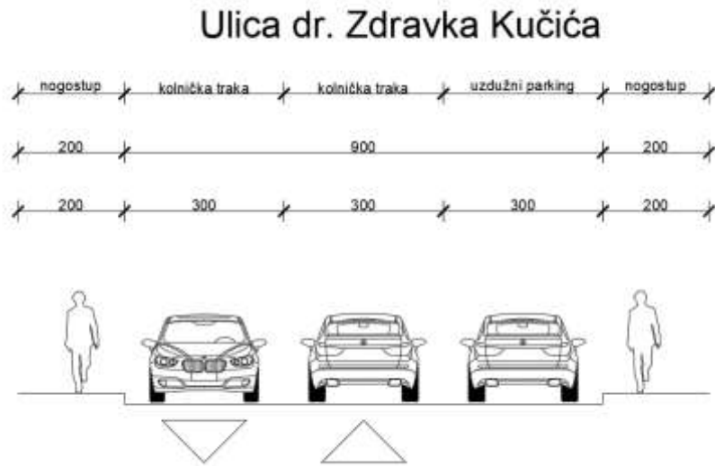
Slika 17: Poprečni presjek Ulice doktora Zdravka Kučića
