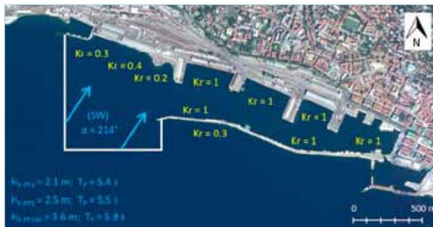
Slika 23: Akvatorijalno područje obuhvaćeno prostornom domenom numeričkog modela valnih deformacija s naznačenim koeficijentima refleksije (Lončar, Carević i Paladin, 2014.)
