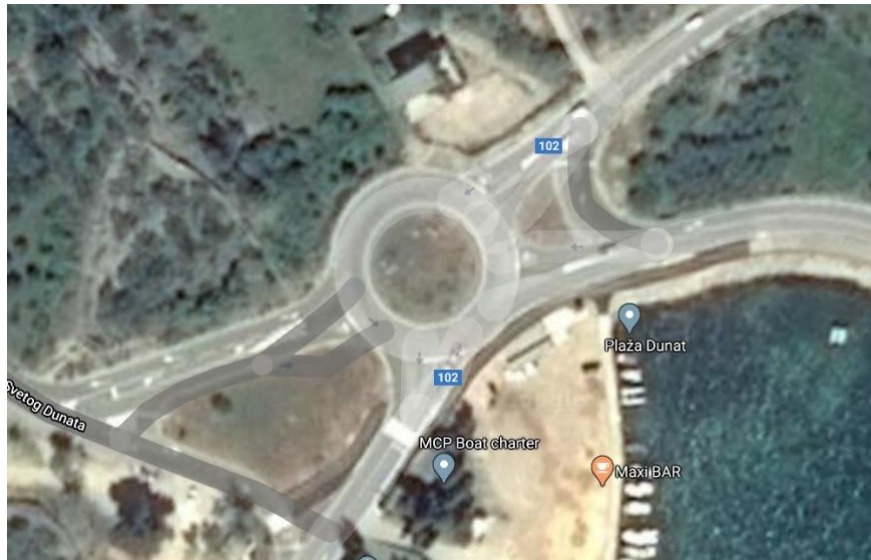
Slika br.13: Primjer lošeg vođenja privoza, kružno raskrižje na otoku Krku [12]
