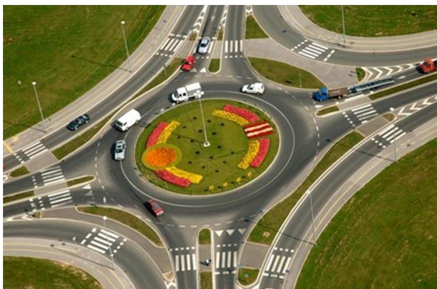
Slika br.16: Kružno raskrižje s odvojenim trakama za desno skretanje [14]
