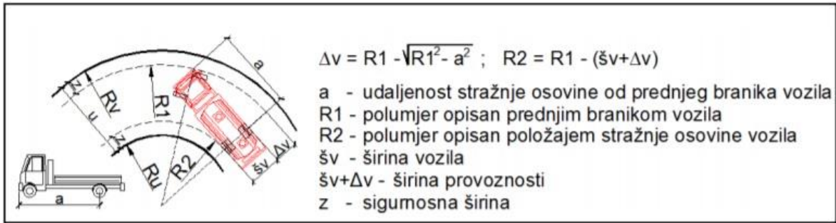
Slika br. 17: Širina kružnog kolnika za mjerodavno dvoosovinsko vozilo [2]
