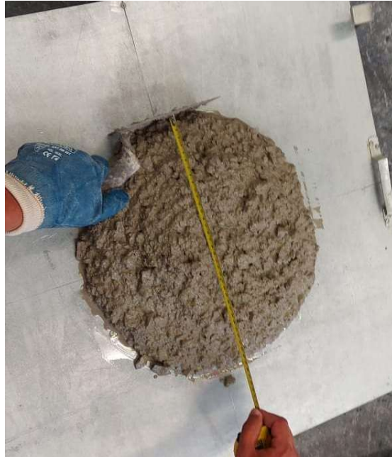
Slika 28. Mjerenje rasprostiranja svježeg betona
