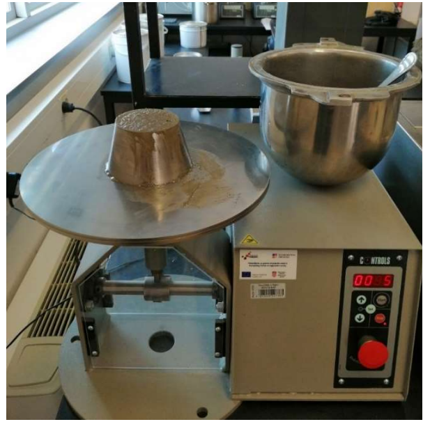
Slika 5. Kalup i uređaj za rasprostiranje
