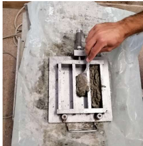
Slika 7. Punjenje kalupa na vibrostolu
