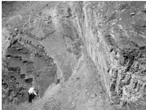
Slika 14. Klin formiran od platforme (s lijeva) te veznog materijala (s desna), klizište se događa na platformi – škriljevci (Wyllie and Mah, 2005)
